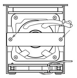
**8.** Befestigen Sie die schmale Metallplatte mit den zwei Schrauben auf der Rückseite.
