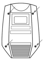
**9.** Schließen Sie das Gehäuse mit den beiden Abdeckungen und verschrauben Sie diese mit jeweils vier Kreuzschlitzschrauben.
