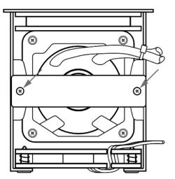
Lösen Sie nun die schmale Metallplatte auf der Rückseite, indem Sie die zwei Schrauben herausdrehen.
