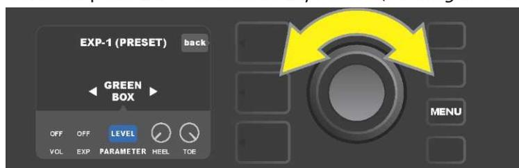
Desplácese hasta la opción "PARAMETER" utilizando el ENCODER (señalado con una flecha amarilla). En este ítem se encuentran los diferentes controladores del efecto, resaltado en el NIVEL DE RUTA DE SEÑAL. En el ejemplo mostrado uno de los parámetros del efecto es el parámetro de distorsión Green Box "LEVEL". Este parámetro puede asignarse al pedal EXP-1.
