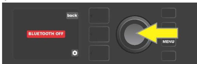
*El estado por defecto del Bluetooth es apagado ("off") (indicado con texto sobre un campo rojo). Pulse el botón del ENCODER para encender el Bluetooth (indicado con texto sobre un campo verde).*
