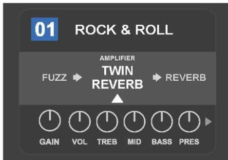
*En este ejemplo de NIVEL DE RUTA DE SEÑAL de la preselección, se indica el nombre del modelo de amplificador elegido en la preselección (señalado con una flecha blanca y con una etiqueta textual "amplifier" - amplificador), mientras que a ambos flancos aparecen los nombres de los efectos.*
