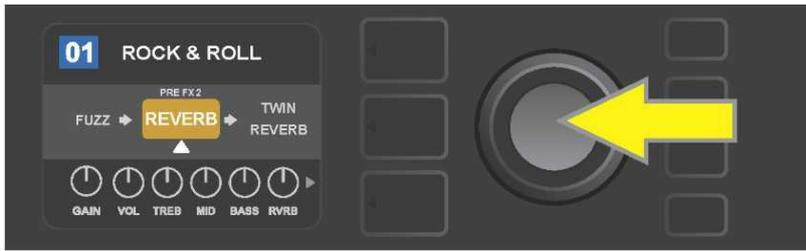
Tras desplazar el efecto elegido girando el ENCODER, seleccione la nueva posición del efecto en la ruta de señal pulsando el ENCODER.
