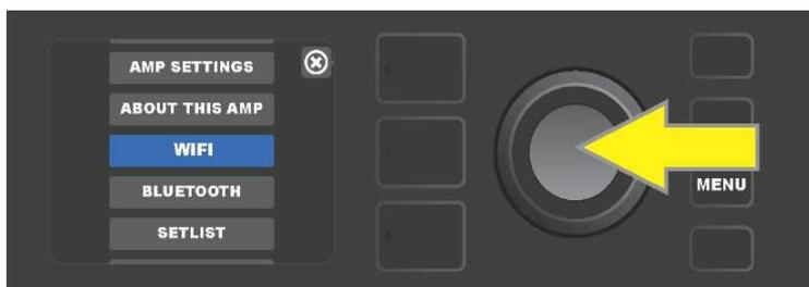
Desplácese por el menú con ayuda del ENCODER hasta la posición "WiFi", seguidamente acceda a los ajustes de WiFi pulsando el botón del ENCODER.
