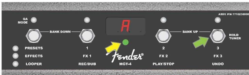
En el ejemplo indicado el tono "A" se muestra como correctamente afinado, una circunstancia indicada con el diodo LED verde de FUNCIÓN situado en el centro bajo el DISPLAY (marcado con una flecha amarilla). Tras finalizar el afinado pise el botón FUNCIÓN 3 (marcado con una flecha verde) para abandonar el modo de afinado con el footswitch.
