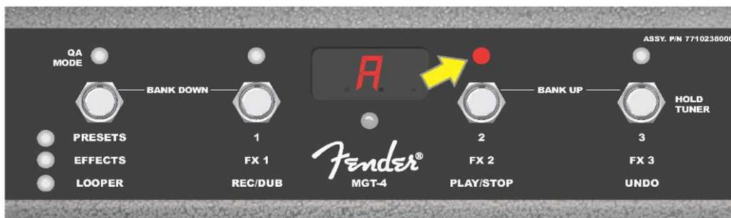
En el ejemplo mostrado aparece el tono "A" afinado ligeramente por encima, una circunstancia indicada con el diodo LED rojo de FUNCIÓN en la parte superior derecha más cercana al centro (marcada con una flecha amarilla).
