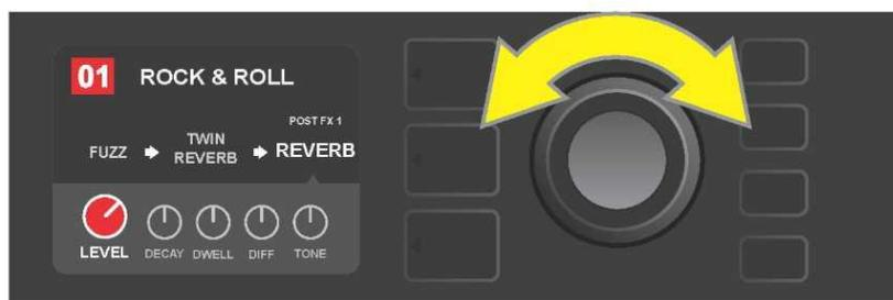
Elija la configuración del controlador de efecto requerida girando el ENCODER.
