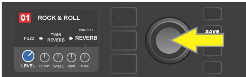
Guarde la configuración del controlador modificada pulsando el ENCODER. El color del controlador volverá a cambiar a azul.
