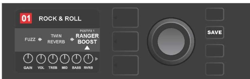
Tras configurar el remplazo del efecto (en la imagen aparece indicada con una flecha blanca debajo y una etiqueta situada sobre el efecto) podrá continuar editando otros parámetros o podrá guardar las modificaciones realizadas pulsando el botón de funcionamiento iluminado SAVE.
