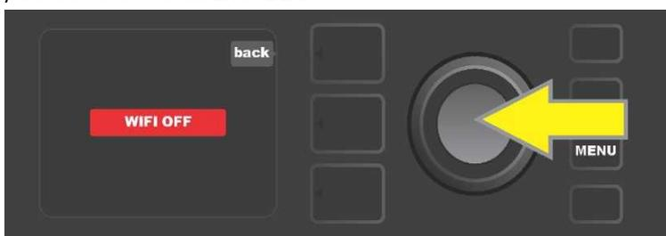
El estado por defecto del WiFi es apagado ("off") (indicado con texto sobre un campo rojo). Pulse el botón del ENCODER para encender el WiFi (indicado con texto sobre un campo verde).
