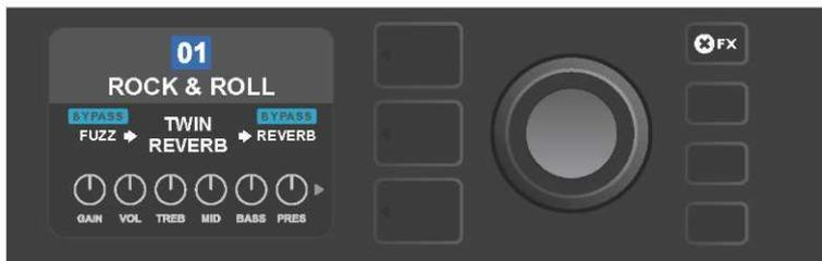
Al pulsar el botón de función "X FX", el botón se ilumina, todos los efectos en todas las preselecciones se omiten (tal y como se indica mediante la etiqueta "BYPASS" en el campo azul sobre el nombre de cada efecto).
