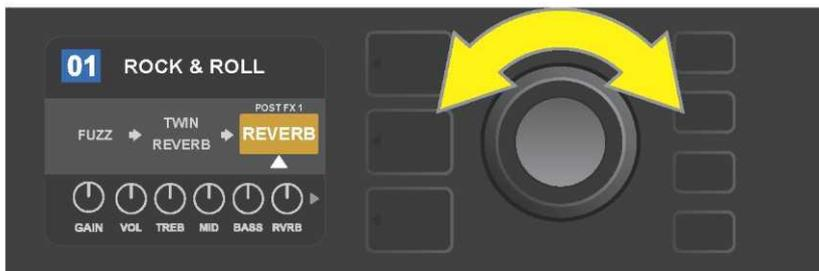
*El efecto elegido, resaltado y señalado con una flecha blanca por debajo y con una etiqueta sobre el efecto, aparecerá en un campo naranja que indica que el efecto está preparado para su desplazamiento a otra posición en la ruta de señal. Desplace el efecto girando el ENCODER.*
