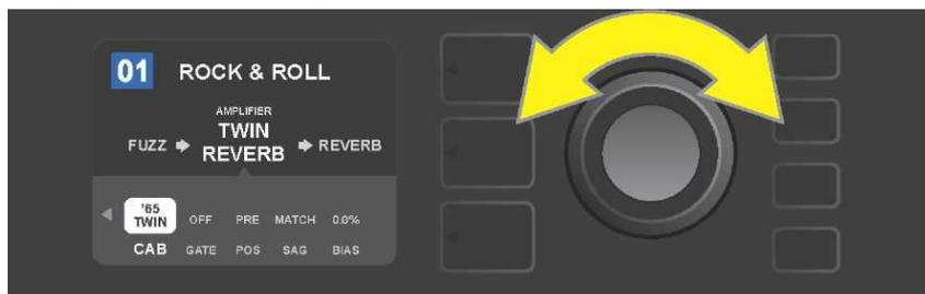
Con ayuda del ENCODER podrá desplazarse por el NIVEL DE CONTROLADORES entre los diferentes controladores, así como seleccionar un controlador concreto y modificar sus ajustes.
