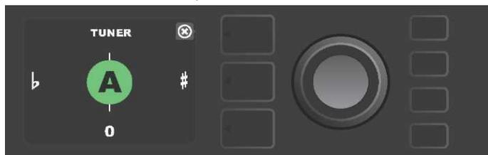
Si el afinado se produce de manera correcta, el tono tocado aparecerá en un círculo verde situado sobre la línea vertical central.
