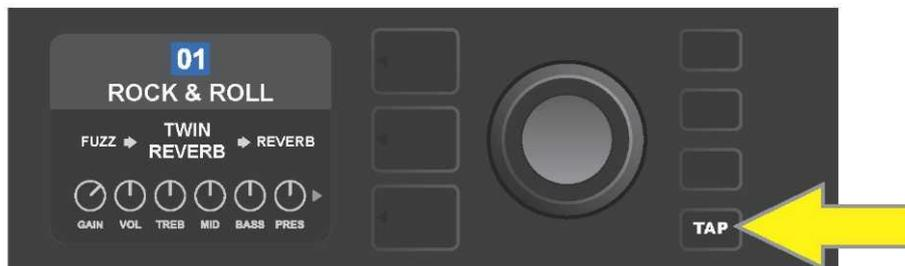
*Si quiere modificar el tempo del primer efecto del eco (o la modulación en caso de que no se aplique ningún efecto de eco), pulse sobre el botón de función TAP al ritmo requerido.*
