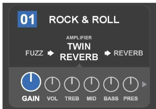
*Imagen detallada del NIVEL DE CONTROLADORES de una preselección concreta, donde se ha seleccionado el control de ganancia del modelo de amplificador.*
