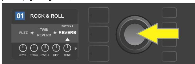
*Otra posibilidad de añadir un efecto: resalte el efecto existente de una preselección girando el ENCODER, a continuación pulse el ENCODER para mostrar un menú con las cuatro categorías de efectos.*
