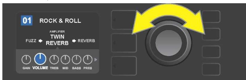
Al girar el ENCODER se desplazará entre los controladores del modelo de amplificador.
