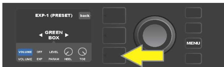
Si quiere asignar el EXP-1 a un efecto concreto en el marco de una preselección específica, pulse el botón de NIVEL DE CONTROLADORES (marcado con una flecha amarilla), de manera que se permita el acceso a los ítems que contienen la configuración de los parámetros de efecto ("PARAM"). En el ejemplo mostrado el EXP-1 servirá para controlar el efecto de stompbox overdrive Green Box.
