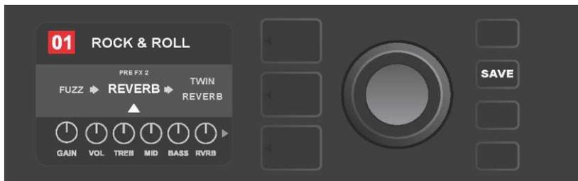
Tras desplazar el efecto a una nueva posición (en la imagen aparece indicada con una flecha blanca debajo y una etiqueta situada sobre el efecto) podrá continuar editando otros parámetros o podrá guardar las modificaciones realizadas pulsando el botón de funcionamiento iluminado SAVE.
