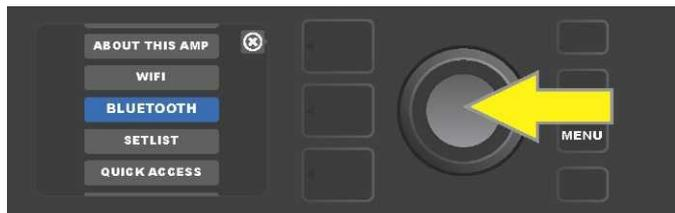
*Desplácese con el ENCODER hasta la opción "BLUETOOTH", a continuación pulse el ENCODER para acceder a los ajustes del Bluetooth.*
