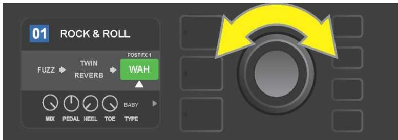
El nuevo efecto añadido, resaltado y señalado con una flecha blanca por debajo y con una etiqueta sobre el efecto, aparecerá en un campo verde que indica la posibilidad de dejar el efecto en dicha posición o de desplazarlo a otra posición en la ruta de señal. Desplace el efecto girando el ENCODER.
