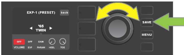
Gire el ENCODER (señalado con una flecha amarilla) para desplazarse por la opción "OFF". Pulse el botón del ENCODER para confirmar esta opción. La función del modo Volume del pedal EXP-1 para el amplificador mostrado en el NIVEL DE RUTA DE SEÑAL está ahora apagada. El color del campo señalado volverá a su azul original. Al pulsar el botón de función SAVE (flecha verde) guardará los cambios realizados.
