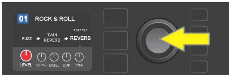
Elija el controlador concreto cuya configuración quiera modificar pulsando el ENCODER. El color volverá al rojo.
