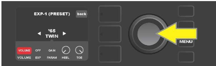
Pulse el "ENCODER" sobre "VOLUME". El color del campo señalado cambiará de azul a rojo, indicando que a partir de ese momento podrá realizar cambios en los ajustes.
