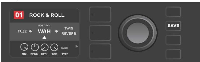
Tras añadir el efecto a la posición (en la imagen aparece indicada con una flecha blanca debajo y una etiqueta situada sobre el efecto) podrá continuar editando otros parámetros o podrá guardar las modificaciones realizadas pulsando el botón de funcionamiento iluminado SAVE.
