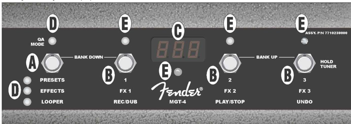
**A. BOTÓN MODE** Sirve para seleccionar uno de los cuatro modos: QUICK ACCESS QA (Acceso rápido), PRESETS (Preselecciones), EFFECTS (Efectos) y LOOPER (Bucle).
