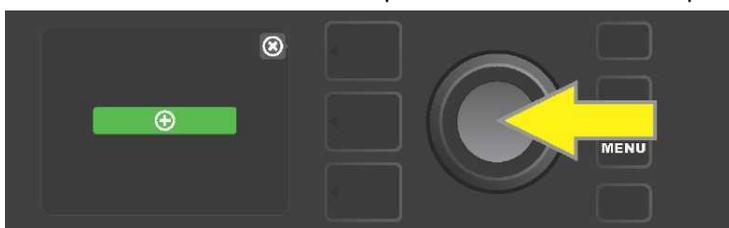
Desplácese utilizando el ENCODER entre las preselecciones. Pulse el ENCODER para elegir la preselección deseada y añadirla al SETLIST 1:
