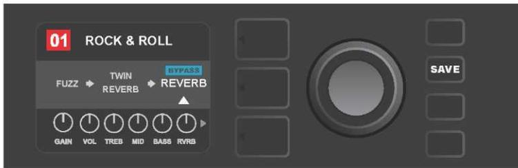
*Tras elegir la omisión del efecto (en la imagen aparece indicada con una flecha blanca debajo y una etiqueta en un campo azul "BYPASS" situada sobre el efecto) podrá continuar editando otros parámetros o podrá guardar las modificaciones realizadas pulsando el botón de funcionamiento iluminado SAVE.*
