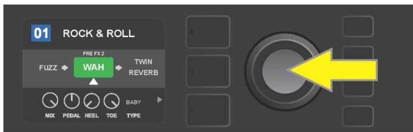
Tras trasladar el nuevo efecto añadido girando el botón ENCODER, elija una nueva posición del efecto en la ruta de señal pulsando el botón ENCODER.
