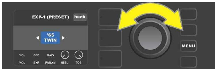
En la CONFIGURACIÓN PARA LA PRESELECCIÓN EXP-1: En el NIVEL DE RUTA DE SEÑAL aparecerán, uno tras otro, el amplificador y los efectos de la preselección a los que puede asignarse el pedal EXP-1. Podrá desplazarse con el ENCODER entre las diferentes opciones. En el ejemplo indicado a continuación aparece resaltado el amplificador '65 Twin.
