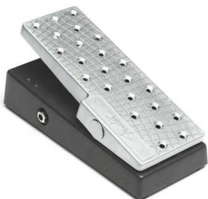
Prepare el pedal EXP-1 para su uso del siguiente modo: conecte el pedal a la toma del footswitch en el panel tarsero del amplificador y encienda el amplificador. Pulse el botón de función MENU en el amplificador y con ayuda del ENCODER desplácese por las opciones del menú. Elija en el menú abajo indicado la opción "EXP-1 SETUP" (ver imagen a continuación).
