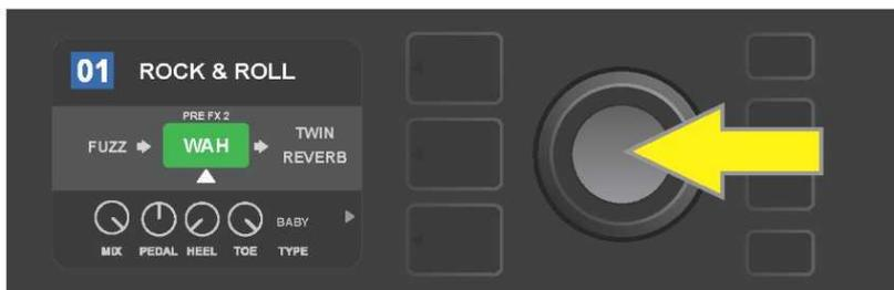
Tras trasladar el nuevo efecto añadido girando el botón ENCODER a la posición requerida, elija una nueva posición del efecto en la ruta de señal pulsando el botón ENCODER.
