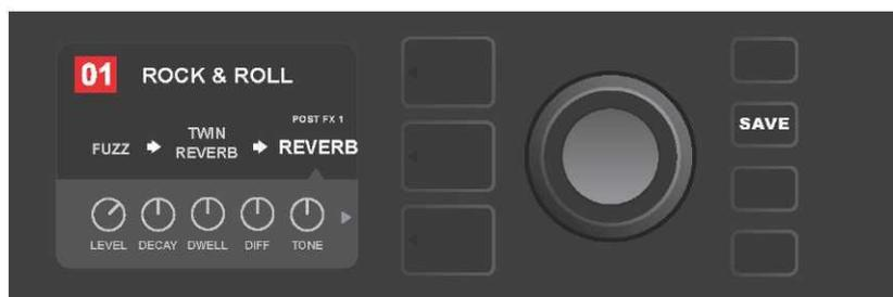
Tras modificar la configuración del controlador concreto del efecto podrá continuar realizando cambios en otros parámetros, o bien podrá guardar las modificaciones realizadas pulsando el botón de función SAVE.
