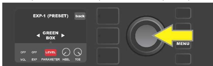
En el ejemplo arriba mostrado: pulse el ENCODER (señalado con una flecha amarilla) sobre la opción "LEVEL". El campo de esta opción cambia de azul a rojo, indicando así que pueden modificarse los ajustes de este parámetro del efecto Green Box overdrive para su control con el pedal EXP-1.
