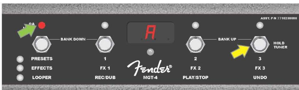
Active el afinador mediante el footswitch MGT-4 manteniendo pisado brevemente el botón de FUNCIÓN 3 (señalado con una flecha amarilla). En el ejemplo mostrado aparece el tono "A" afinado ligeramente por debajo, una circunstancia indicada con el diodo LED rojo de FUNCIÓN en la parte superior derecha (marcada con una flecha verde).
