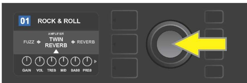
El modelo señalado modificado de amplificador en la preselección en el NIVEL DE RUTA DE SEÑAL (aparece indicado con una flecha blanca bajo el nombre y con la etiqueta textual "amplifier" – amplificador sobre el nombre del amplificador). Si quiere cambiar el modelo de amplificador, primero pulse el ENCODER, de esta manera podrá entrar en el menú de modelos de amplificadores.
