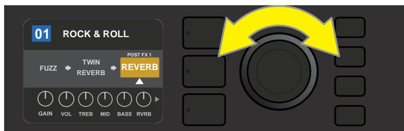
L'effetto selezionato, evidenziato con una freccia bianca sotto di esso e un'etichetta al di sopra, viene visualizzato in una casella arancione per indicare che è pronto per essere spostato in una diversa posizione nel percorso del segnale ruotando l'ENCODER.
