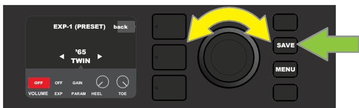
Ruotare l'ENCODER (freccia gialla) su "OFF", quindi premere per selezionare l'impostazione "OFF". La funzione del pedale in modalità Volume di EXP-1 per l'amplificatore illustrato nel SIGNAL PATH LAYER ora è disattivata, e la casella dell'etichetta ritornerà blu. Premere il pulsante di utilità SAVE (freccia verde) per mantenere le modifiche.
