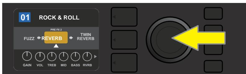
*Dopo aver spostato l'effetto selezionato ruotando l'ENCODER, premere quest'ultimo per selezionare la nuova posizione nel percorso del segnale.*
