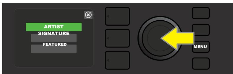
Una volta selezionata una categoria di preset nel cloud premendo l'ENCODER su di essa, scorrere l'elenco dei preset visualizzati (freccia gialla nell'illustrazione che segue). Il preset evidenziato sarà automaticamente riprodotto/presentato in anteprima. Per aggiungere un preset evidenziato all'amplificatore, premere il pulsante di utilità SAVE (freccia verde).
