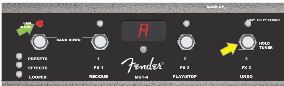
Per attivare la funzione accordature dell'interruttore a pedale MGT-4, battere e tenere premuto brevemente il pulsante FUNZIONE 3 (freccia gialla). Nell'esempio illustrato qui viene visualizzata una nota "A" particolarmente stonata verso il bemolle, come indicato dal LED di FUNZIONE rosso all'estremità superiore sinistra (freccia verde).
