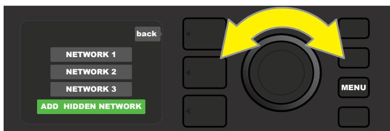
È possibile accedere manualmente a una rete scorrendo fino alla voce "ADD HIDDEN NETWORK" e selezionandola, per poi inserire i caratteri ruotando e premendo l'ENCODER.
