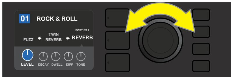
Nel CONTROLS LAYER, evidenziare un controllo di effetto scorrendo verso di esso utilizzando l'ENCODER; ciascun controllo di effetto diventa blu quando viene evidenziato.
