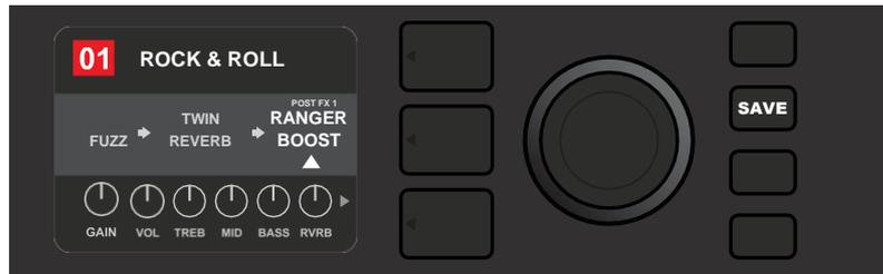
Una volta sostituito l'effetto (come indicato qui dalla freccia bianca sotto di esso e dall'etichetta al di sopra), continuare con la modifica di altri parametri oppure premere il pulsante di utilità SAVE illuminato per mantenere le modifiche completate.
