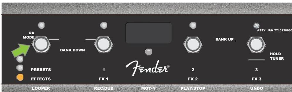
Per iniziare a registrare il primo passaggio musicale, battere il pulsante FUNZIONE 1 (*freccia gialla nell'illustrazione che segue*) etichettato "REC/DUB." Il LED di FUNZIONE rosso sopra il pulsante FUNZIONE 1 inizia a lampeggiare e la finestra del display visualizza "REC", per indicare che il LOOPER è in modalità di registrazione; suonare un passaggio di qualunque durata non superiore a 60 secondi (*vedere l'illustrazione riportata sotto*).
