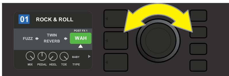
L'effetto appena aggiunto, evidenziato con una freccia bianca sotto di esso e un'etichetta al di sopra, viene visualizzato in una casella verde per indicare che può essere lasciato in quella posizione o spostato in una diversa posizione nel percorso del segnale ruotando l'ENCODER.
