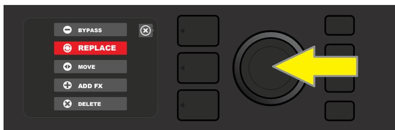
Ruotare l'ENCODER per evidenziare "REPLACE" nel menu di opzioni di posizionamento degli effetti, quindi premere l'ENCODER per selezionarlo.
