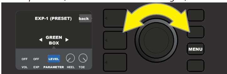
Utilizzare l'ENCODER (freccia gialla) per scorrere fino a "PARAMETER", che comprende i controlli individuali per l'effetto evidenziato nel SIGNAL PATH LAYER. Nell'esempio illustrato qui, "LEVEL" è uno dei parametri di overdrive Green Box che è possibile assegnare all'EXP-1.
