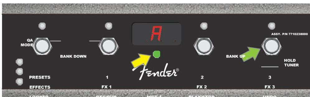
Nell'esempio illustrato qui la nota "A" viene visualizzata all'intonazione giusta, come indicato dal LED di FUNZIONE verde centrato sotto la FINESTRA DEL DISPLAY (freccia gialla). Una volta completata l'accordatura, battere il pulsante FUNZIONE 3 (freccia verde) per uscire dalla funzione di accordatura dell'interruttore a pedale.
