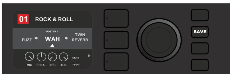
Una volta aggiunto l'effetto in posizione (come indicato qui dalla freccia bianca sotto di esso), continuare con la modifica di altri parametri oppure premere il pulsante di utilità SAVE illuminato per mantenere le modifiche completate.
