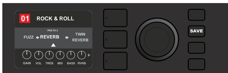
*Una volta spostato l'effetto in una nuova posizione (come indicato qui dalla freccia bianca sotto di esso e dall'etichetta al di sopra), continuare con la modifica di altri parametri oppure premere il pulsante di utilità SAVE illuminato per mantenere le modifiche completate.*
