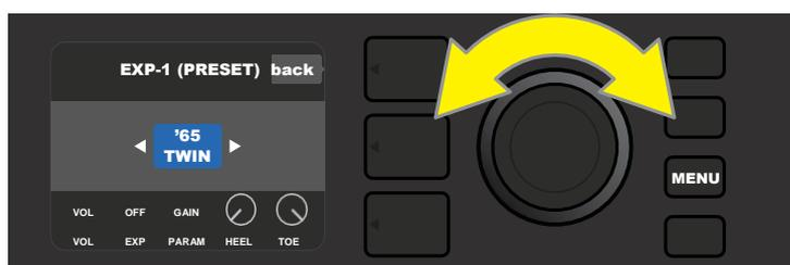
In EXP-1 PRESET SETTINGS, l'amplificatore e gli effetti di quel preset ai quali è possibile assegnare l'EXP-1 sono visualizzati uno alla volta nel SIGNAL PATH LAYER; si utilizza l'ENCODER per scorrere tra di essi. Nell'esempio precedente, è evidenziato un amplificatore '65 Twin.
