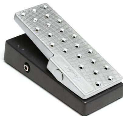
Per configurare il pedale EXP-1 per l'uso, connetterlo al jack dell'interruttore a pedale sul retro dell'amplificatore e accendere l'amplificatore. Premere il pulsante di utilità MENU, quindi utilizzare l'ENCODER per scorrere e selezionare "EXP-1 SETUP" dal menu visualizzato (vedere l'illustrazione riportata sotto).
