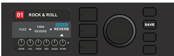
*Una volta escluso l'effetto (come indicato qui dalla freccia bianca sotto di esso e dalla casella blu contenente l'etichetta da "BYPASS" sopra di essa), continuare con la modifica di altri parametri oppure premere il pulsante di utilità SAVE illuminato per mantenere le modifiche completate.*
