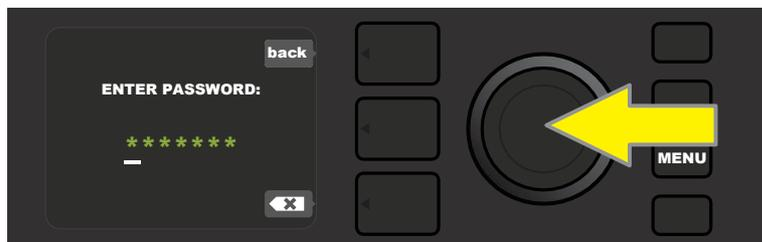
Dopo aver selezionato "CONNECT", immettere una password ruotando e premendo l'ENCODER per aggiungere i singoli caratteri.
