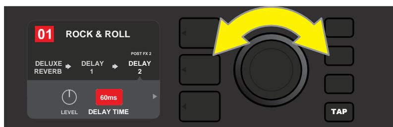
*È anche possibile modificare il tempo degli effetti di ritardo e modulazione evidenziando il valore numerico del parametro di tempo nel CONTROLS LAYER e poi premendo e ruotando l'ENCODER per impostare il tempo desiderato.*
