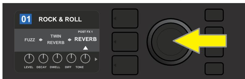
Un altro modo per aggiungere un effetto consiste nell'evidenziare un effetto esistente all'interno di un preset ruotando l'ENCODER verso di esso e premendolo per visualizzare un menu di quattro categorie di effetti.
