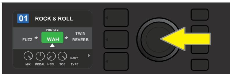
Dopo aver spostato l'effetto appena aggiunto ruotando l'ENCODER, premere quest'ultimo per selezionare la nuova posizione nel percorso del segnale.
