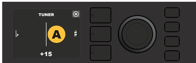
Se una nota non è accordata, la nota suonata verrà visualizzata in un cerchio giallo a sinistra (bemolle) o a destra (diesis) della linea centrale verticale. Il valore di intonazione in centesimi viene visualizzato in fondo.
