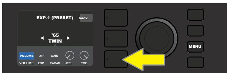
In questo esempio, per disattivare la funzione del pedale in modalità Volume di EXP-1 per l'amplificatore '65 Twin mostrato nel SIGNAL PATH LAYER, premere il pulsante CONTROLS LAYER. La modalità "VOLUME" sarà evidenziata automaticamente nel CONTROLS LAYER.
