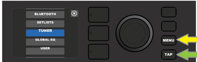
Per accedere all'accordatore, premere il pulsante di utilità MENU (freccia gialla) per ottenere un elenco di opzioni che comprendono l'accordatore, oppure premere e tenere premuto il pulsante di utilità TAP (freccia verde).
