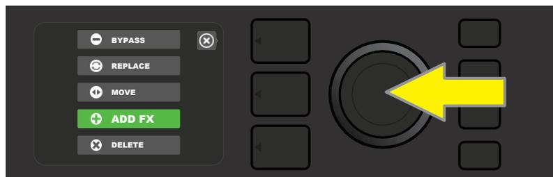
Selezionare "ADD FX" nel menu di opzioni di posizionamento degli effetti scorrendo verso di esso e premendo l'ENCODER.
