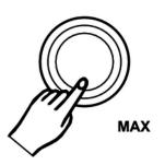
Stellen Sie mit dem Drehregler [VOLUME] eine für die Wiedergabe und das Üben angenehme Lautstärke ein. Drehen Sie den Regler im Uhrzeigersinn, um die Lautstärke zu erhöhen. Drehen Sie ihn entgegengesetzt, um die Lautstärke zu verringern.
