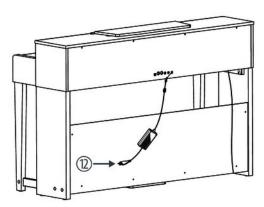
Stecken Sie den DIN-Stecker des Pedalkabels in die vorgesehene Buchse auf der Unterseite des Digitalpianos. Stecken Sie den Netzstecker in die vorgesehene Buchse auf der Rückseite des Digitalpianos. Fixieren Sie die Kabel am Untergestell und bewegen Sie das Digitalpiano an den gewünschten Standplatz.
