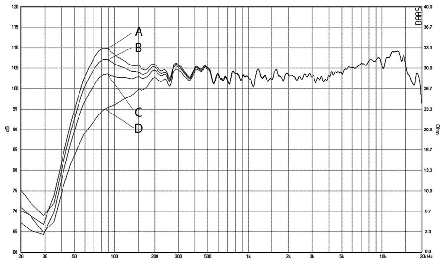
L'illustration ci-dessous indique la réponse en fréquence en fonction du réglage dans le point de menu « *LOCATION* »:
