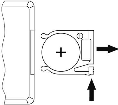
Drücken Sie die Sperre des Batteriehalters zur Gehäusemitte und ziehen Sie den Batteriehalter wie eine Schublade heraus. Legen Sie die Batterie ein. Die Batterie liegt richtig, wenn der Pluspol zum Gehäuseboden der Fernbedienung zeigt. Schieben Sie den Batteriehalter zurück in die Fernbedienung, bis er einrastet.
