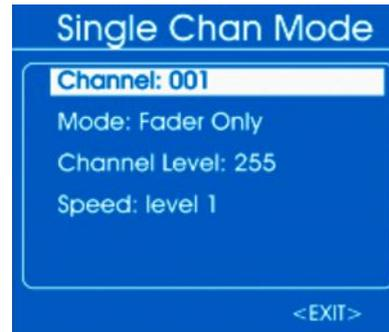
5. ▶ Um den Kanal auszuwählen, auf dem die Daten gesendet werden sollen, wählen Sie den Punkt „Channel“. Drücken Sie das Jog Wheel. Stellen Sie mit dem Jog Wheel einen Wert zwischen 1 und 512 ein – oder „All“ für Übertragung auf allen Kanälen.
