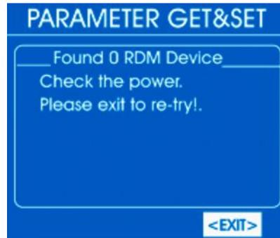
Prüfen Sie in diesem Fall die Verkabelung und den korrekten Sitz der Steckverbinder.
