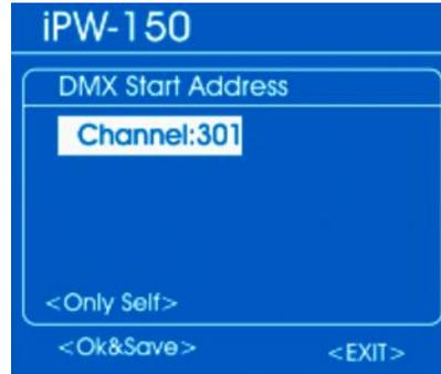
8. ➤ Wählen Sie mit dem Jog Wheel den Punkt „Channel:“ und drücken Sie das Jog Wheel. Stellen Sie den gewünschten Wert mit dem Jog Wheel ein. Bestätigen Sie durch Drücken des Jog Wheels.
