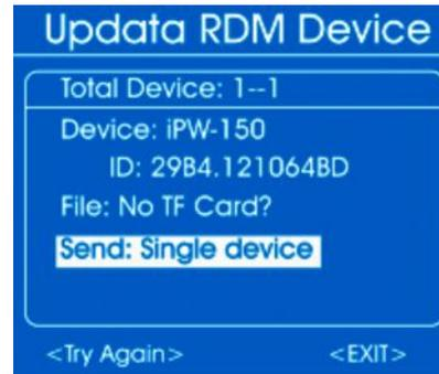
5. ➤ Um einen Parameter abzurufen, wählen Sie ihn mit dem Jog Wheel aus und drücken Sie das Jog Wheel. Wählen Sie „*Single device*“ (Übertragung an ein Gerät) oder „*All devices*“ (Übertragung an alle Geräte) und drücken Sie das Jog Wheel.
