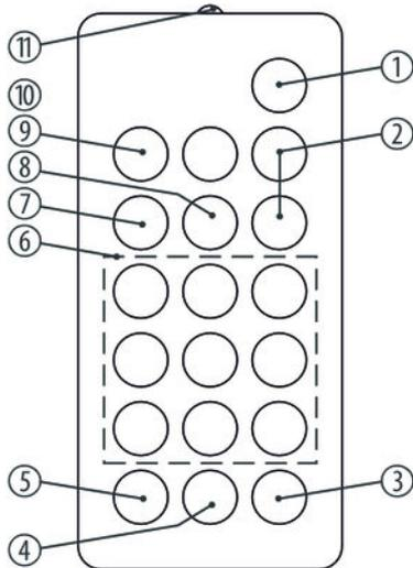
Zum Verwenden der Fernbedienung richten Sie sie mit der Infrarot-Diode auf den Infrarot-Sensor am Gerät aus und drücken Sie die gewünschten Tasten. Die maximale Entfernung vom Gerät liegt bei ca. 9 m. Das Gerät reagiert nur auf die Signale der Fernbedienung, wenn es nicht über DMX gesteuert wird.
