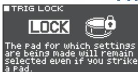
Wenn die Trigger Lock-Funtion aktiviert ist, blinkt die Anzeige der aktuell gewählten Trigger-Eingangsnummer. Sie können während der Editierung den gewünschten Drum Trigger durch Drücken einer der Trigger-Taster umschalten.
