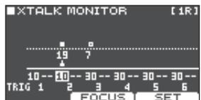
Wenn der Übersprech-Effekt für mehrere Drum Trigger auftritt, werden durch mehrfaches Drücken des [F2] (FOCUS)-Tasters die Drum Trigger nacheinander ausgewählt ist, bei denen der Übersprech-Effekt auftritt.
