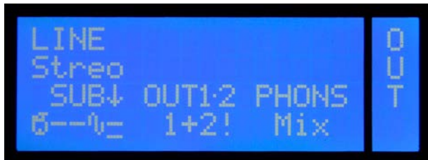
Den Output-Buchsen OUT1-2 werden die Busse 1 und 2 zugeordnet
