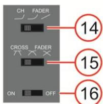
14. Interrupteur de sélection de la courbe du fader
