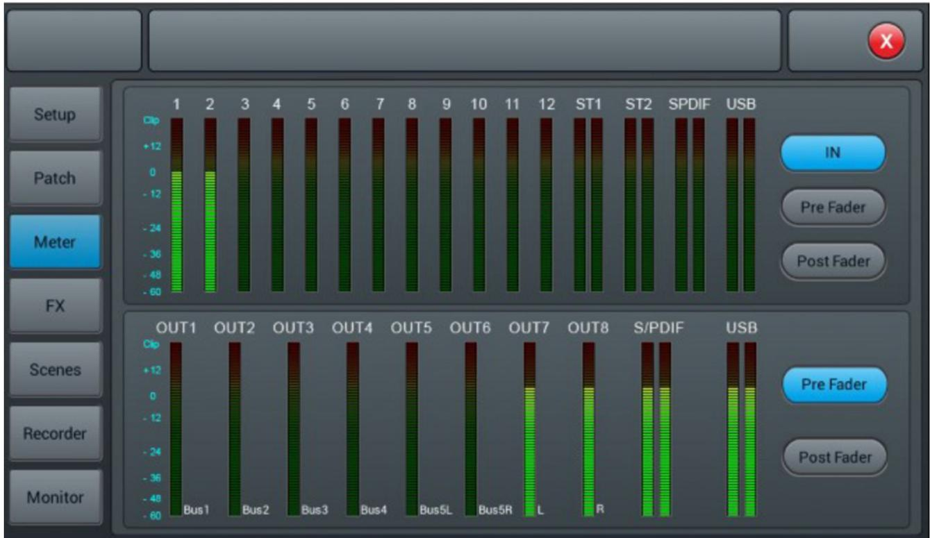
Die Verarbeitung der Eingangssignale erfolgt in den Modi IN, Pre-Fader und Post-Fader. Voreinstellung: Pre-Fader. Die Auswahl erfolgt über die drei Tasten rechts neben den Eingangs-Anzeigen.
