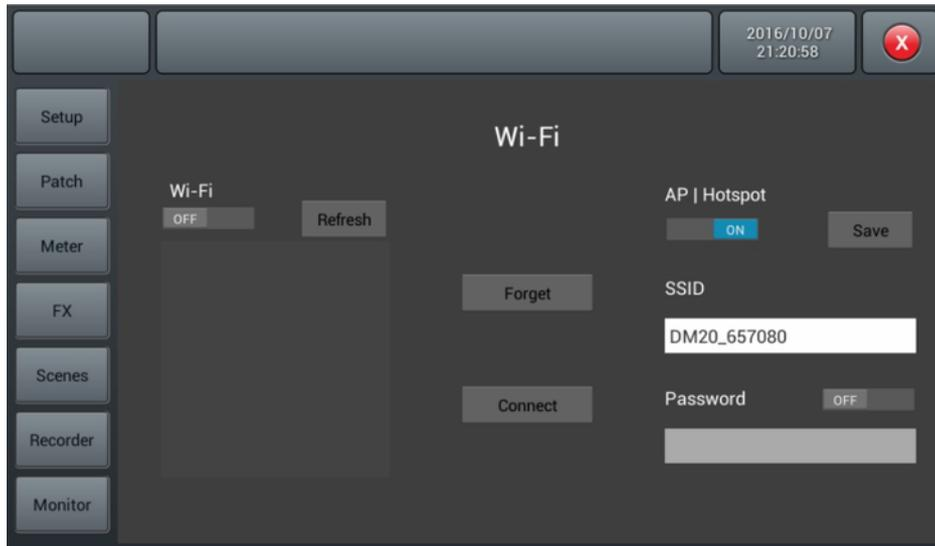
Deaktivieren Sie die WiFi-Funktion [WiFi - OFF] und aktivieren Sie die AP-Funktion [AP-/Hotspot - ON]. Tragen Sie unter [SSID] die Standard-AP-Bezeichnung des Mixers ein. Diese Bezeichnung kann geändert werden. Legen Sie falls gewünscht ein Passwort fest.
