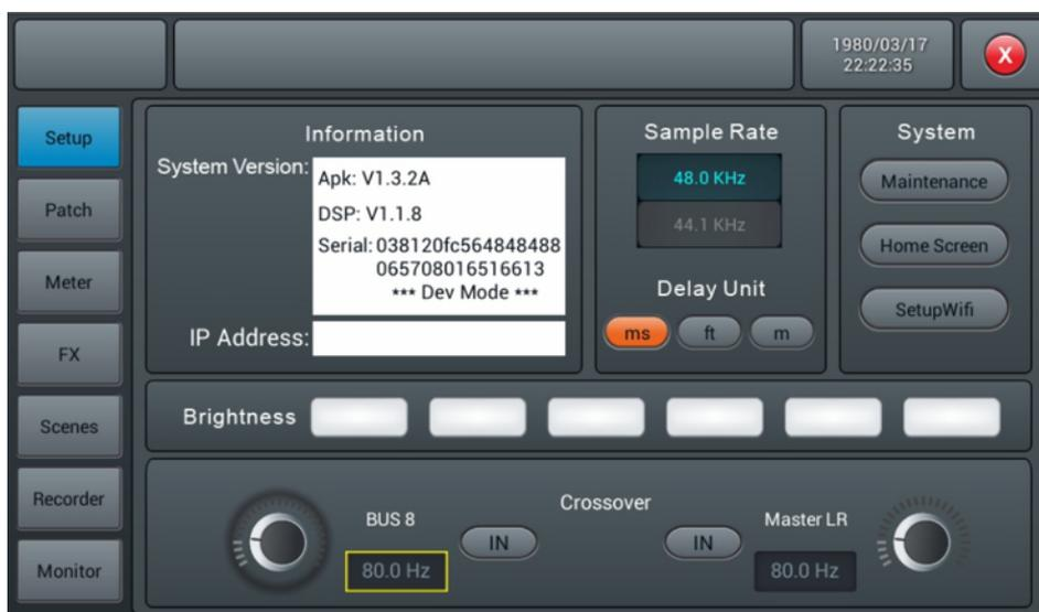
Drücken Sie *[SetupWifi]*. Wenn das WiFi-Modul am Gerät angeschlossen ist, erscheint die folgende Maske.
