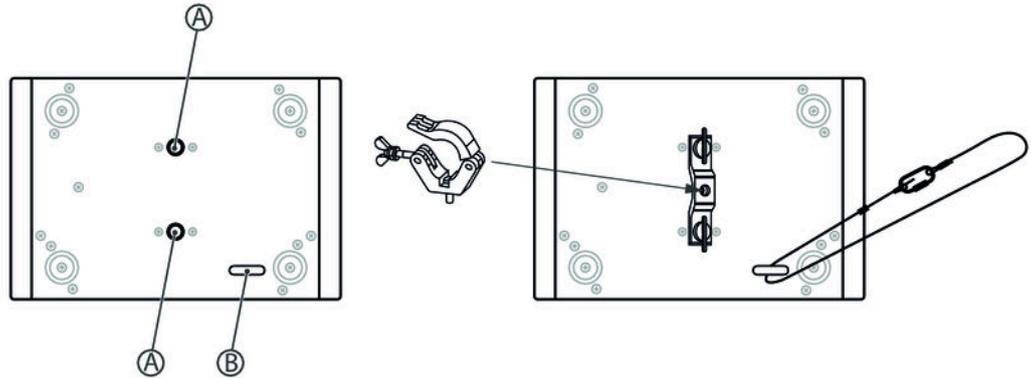
Die Gewinde an der Gehäuseunterseite (A) dienen zur sicheren Montage des mitgelieferten Haltebügels. Daran können Flugadapter (Half Coupler, Trigger Clamps, C-Haken u.ä.) befestigt werden. Sicherheitsfangseile werden durch die Öse (B) an der Gehäuseunterseite geführt.
