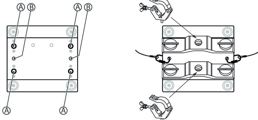
Die Quick-Lock-Aufnahmen an der Gehäuseunterseite (A) dienen zur sicheren Montage der mitgelieferten Haltebügel. Daran können Flugadapter (Half Coupler, Trigger Clamps, C-Haken u.ä.) befestigt werden. Sicherheitsfangseile werden durch die Sicherheitsösen (B) an der Gehäuseunterseite geführt.
