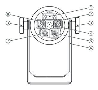
1 Écran et pavé de touches [MENU] Active le menu principal, passe entre les niveaux de menu ou ferme un sous-menu. [DOWN] décrémente la valeur affichée d'une unité. [UP] incrémente la valeur affichée d'une unité. [ENTER] Ouvre un sous-menu ou confirme une valeur. 2 [DMX OUT] Sortie DMX, prise XLR à 3 pôles (IP65) 3 Vis de blocage de la poignée 4 Élément de compensation de la pression
