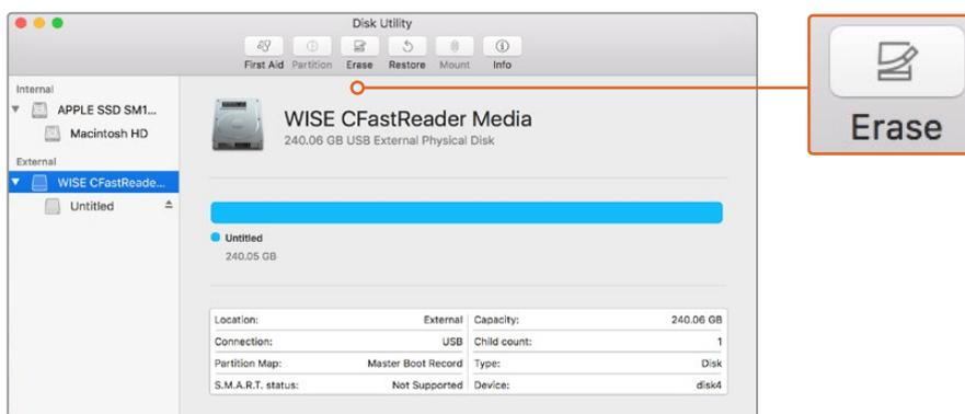
Utilizza l'applicazione Utility disco di Mac per formattare le schede CFast, SD, o le unità USB-C in HFS+ o exFAT. Consigliamo di eseguire un backup, poiché una volta formattato il supporto di memoria i dati non sono recuperabili.
