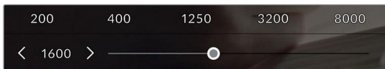
После открытия меню ISO внизу экрана отображаются настройки этого параметра. Слайдер позволяет изменить ISO с шагом 1/3 ступени.
