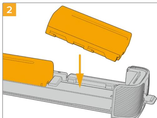
Coloque dos baterías NP-F570 en la base, asegurándose de que se encuentren orientadas correctamente, y deslícelas en sentido opuesto. La pestaña situada entre ambas se alzará para mantenerlas en su lugar. Para extraer las baterías, presione dicha pestaña y deslice una hacia la otra.
