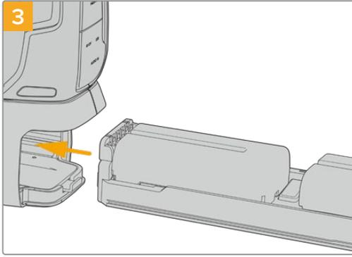
배터리 받침대를 배터리 그립 내부로 삽입한 다음, 잠금 탭을 시계방향으로 돌립니다. 비록 배터리 그립의 배터리를 교환하는 중일지라도, 카메라의 DC 전원 입력에 외부 전원이 연결된 상태라면, 영상을 계속해서 촬영할 수 있습니다.
