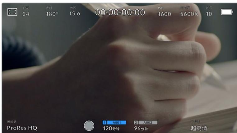
Blackmagic Pocket Cinema Camera可在直方图和音频表的位置显示编解码和分辨率信息。
