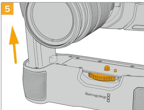
Вставьте выступ рукоятки, имеющий форму батареи, в батарейный отсек камеры. Совместите 1/4-дюймовый винт сверху рукоятки с крепежным отверстием в основании камеры. Для облегчения этой операции рядом с винтом предусмотрен небольшой штырек.
