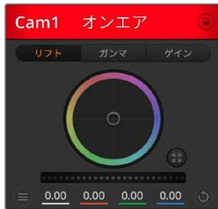
各カメラコントロールにチャンネルの状況が表示されるので、オンエア中のカメラが確認できます。カラーホイールを使用して、各YRGBチャンネルのリフト、ガンマ、ゲイン設定を調整します。
