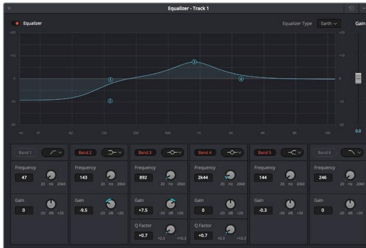
Ecualizador paramétrico de 6 bandas que puede aplicarse a cada pista
