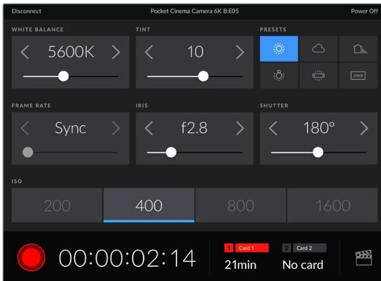
La schermata della app Blackmagic Camera Control abbinata alla camera per regolare i parametri e avviare la registrazione
