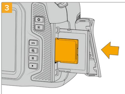
Com a etiqueta do cartão SD voltada para a tela de toque, insira o cartão no compartimento até sentir que ele travou no lugar. O cartão deve ser inserido com facilidade, sem necessidade de força excessiva.
