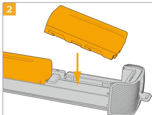
Inserisci due batterie NP-F570 nel vassoio della batteria e slittale verso il lato opposto l'una dall'altra. Una linguetta tra le batterie si sposta leggermente per bloccarle nell'alloggiamento. Per rimuovere le batterie, premi la linguetta verso il basso e slitta le batterie l'una verso l'altra.
