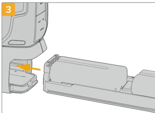
Inserte la base en la empuñadura y gire la pestaña de bloqueo hacia la derecha. Cabe destacar que, si la cámara está conectada a una fuente de alimentación externa, la grabación no se detendrá en el momento de cambiar las baterías en la empuñadura.
