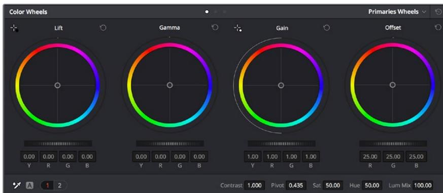
Les roues chromatiques **Lift**, **Gamma**, **Gain** et **Offset** vous offrent un contrôle complet sur l'équilibre des couleurs et des tons de vos clips. Pour régler toutes les couleurs de façon identique, tournez la roue située sous les roues chromatiques
