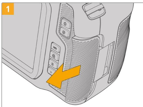
Para acceder a las ranuras de las unidades de almacenamiento, deslice la tapa del compartimento en el lateral derecho hacia la parte posterior de la cámara.
