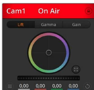
Chaque fenêtre de contrôle de caméra affiche l'état du canal afin que vous sachiez quelle caméra est à l'antenne. Utilisez les roues chromatiques pour ajuster les paramètres Lift, Gamma et Gain de chaque canal YRGB.
