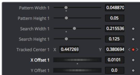
「インスペクタ」の「Tracker」パネルの下部にあるスクロールホイールで、テキストのオフセット位置を調整可能。
