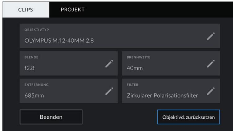
Das Objektivdaten-Menü wird automatisch mit Informationen vom angebrachten Objektiv sowie mit manuell eingegebenen Filterinformationen befüllt
