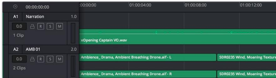
Kanal A1'deki üstbilgi, mono ses için tek şeritli bir mono kanalı gösterir ve A2 kanal üstbilgisi, stereo sesi barındırmak için, bir stereo kanalı iki şerit ile gösterir.
