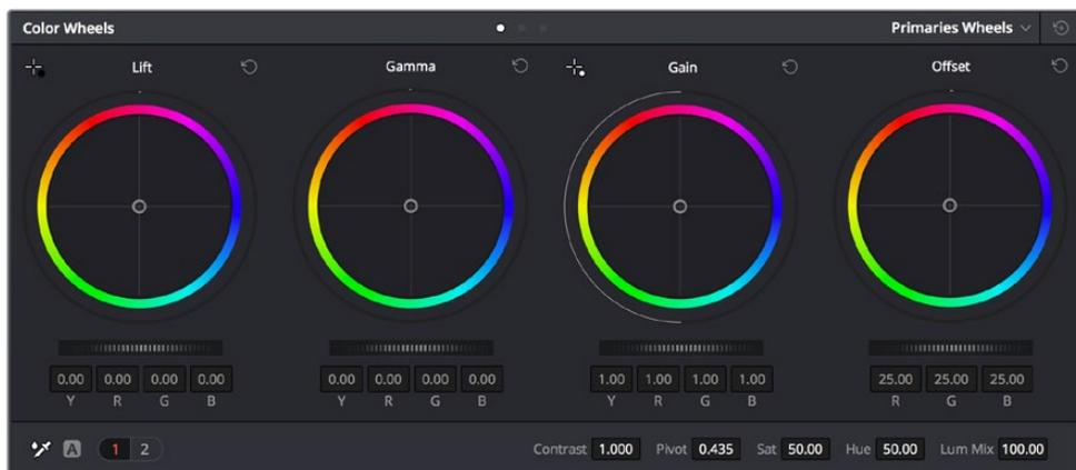
「リフト」、「ガンマ」、「ゲイン」、「オフセット」のカラーホイールで、クリップのカラーおよびトーンのバランスを完全にコントロールできます。各トーン領域のすべてのカラーに同じ調整を加えたい場合は、各カラーホイールの下ダイヤルを左右にドラッグします。
