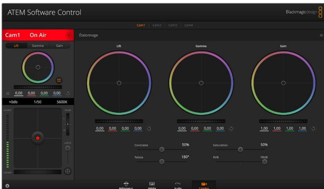
Cliquez sur le bouton DaVinci Resolve pour agrandir la fenêtre de correction colorimétrique et ajuster les paramètres.
