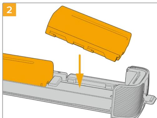
将两块NP-F570电池放入电池槽, 安装时请注意电池朝向, 然后将两块电池逆向滑入电池槽。电池之间的锁定扣向上弹起后, 表示电池锁定到位。移除电池时, 按下锁定扣, 将两块电池相向滑动即可取出。
