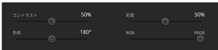
スライダーを左右にドラッグして、コントラスト、彩度、色相、輝度ミックス設定を調整。
