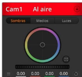
En la parte superior de cada controlador se indica si la cámara está al aire. Utilice los controles generales debajo de cada círculo cromático para ajustar las luces, los tonos intermedios y las sombras en cada canal YRGB.
