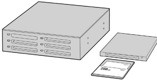
从摄影机上取下CFast或SD卡, 并使用CFast 2.0读写设备或CFast驱动器将其挂载到您的计算机上, 就可直接在您的CFast卡上编辑。
