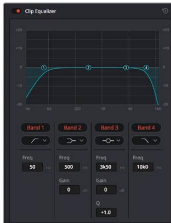
El ecualizador de cuatro bandas puede aplicarse a cualquier clip en la línea de tiempo.
