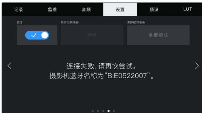
**备注** 当您没有使用蓝牙控制Blackmagic Pocket Cinema Camera时, 出于安全考量建议您关闭蓝牙。
