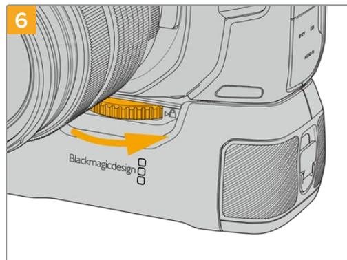
1/4インチネジ前面のノブを右に回してネジをしっかりと留め、カメラにBattery Gripを固定します。
