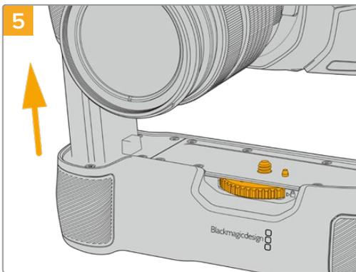
Insira a parte com aspecto de bateria no compartimento de bateria da sua câmera. O parafuso de ¼ de polegada na parte superior do punho de bateria deve estar alinhado com o ponto de encaixe de 1/4-20 na base da câmera. Um pequeno pino junto do parafuso de ¼ de polegada ajuda a manter o alinhamento correto.
