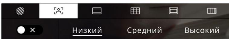
Чтобы установить уровень индикации фокуса, коснитесь соответствующего значка после выбора настроек мониторинга на ЖК-экране
