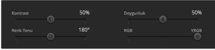
Contrast (kontrast), Saturation (doymunluk), Hue (renk tonu) ve Lum Mix (parlaklık miksi) ayarlarını düzeltmek için, kaydırıcıları sağa veya sola sürükleyin.
