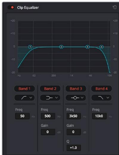
L'equalizzatore a 4 bande è applicabile a ogni clip nella timeline
