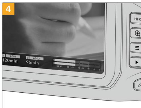
As informações de armazenamento na parte inferior da tela de toque LCD exibirão o nome e o tempo de gravação restante do cartão SD detectado.
