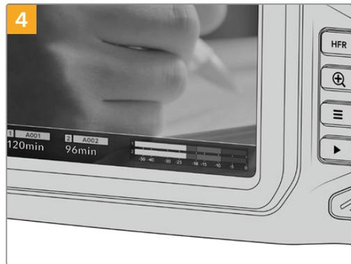
LCD触摸屏底部的存储信息将显示检测到的SD卡名称和剩余记录时间。
