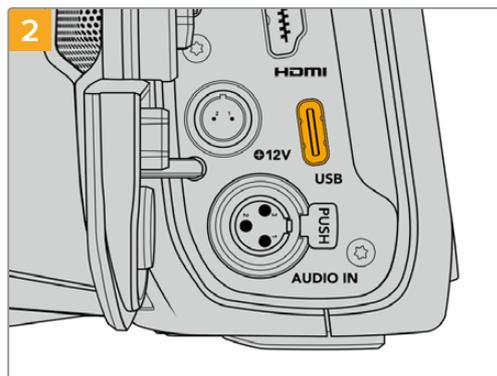
Connectez une extrémité du câble USB de type C au disque flash USB-C.
