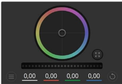
Muovi le rotelle master per regolare Lift, Gamma, e Gain di ciascun canale
