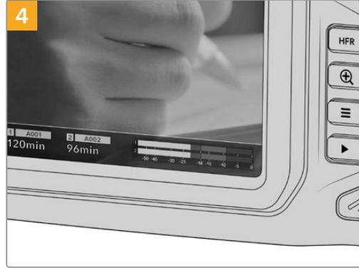
Dokunmatik LCD ekranın altındaki depolama bilgileri, tespit edilen SD kartın adını ve kalan kayıt süresini gösterir.
