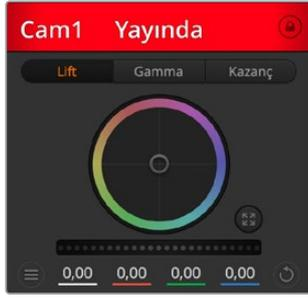
Her kamera kontrolörü, hangi kameranın yayında olduğunu bilmeniz için kanal durumunu gösterir. Her bir YRGB kanalının lift, gamma ve kazanç ayarlarını düzeltmek için renk tekerlerini kullanın.
