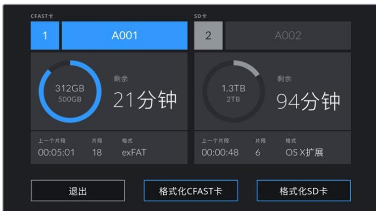
在LCD触摸屏上点按存储卡提示可调出存储管理器界面。
