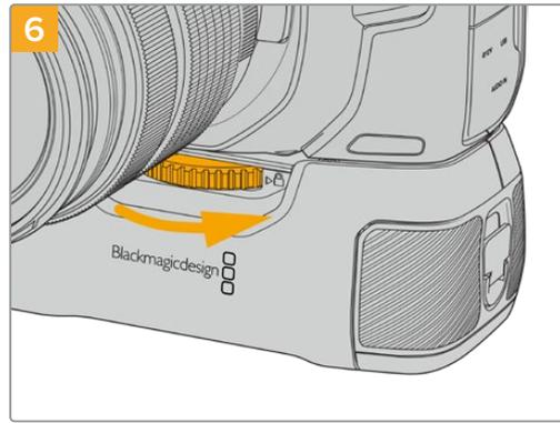
Batarya kulpunun önündeki kontrol düğmesini, vidayı sağlam bir şekilde sıkılamak için sağa çevirin ve batarya kulpunu kameraya sıkıca tutturun.
