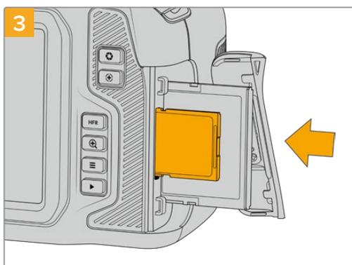
Orientez le côté de la carte SD doté de l'étiquette vers l'écran tactile et insérez la carte dans le logement pour carte SD jusqu'à ce qu'elle s'enclenche. La carte doit pouvoir s'insérer aisément et sans forcer.
