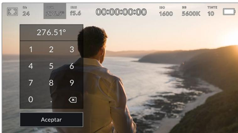
Utilice el teclado numérico para determinar el ángulo de obturación al filmar en exteriores o con luces que no causan parpadeo en la imagen.
