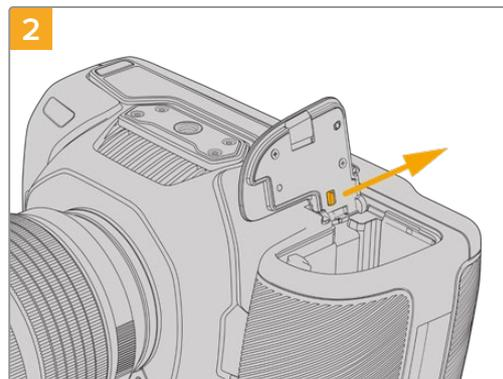
2 カバーのヒンジ近くにあるタブをスライドし、カメラからカバーを取り外します。
