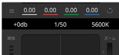
マウスカーソルをゲイン、シャッタースピード、ホワイトバランスのインジケーターに重ねて矢印を表示。クリックして各設定を調整。
