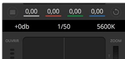
Faites passer le pointeur de votre souris sur les indicateurs de gain, de vitesse d'obturation et de balance des blancs pour faire apparaître les flèches qui vous permettront d'ajuster leurs paramètres respectifs.
