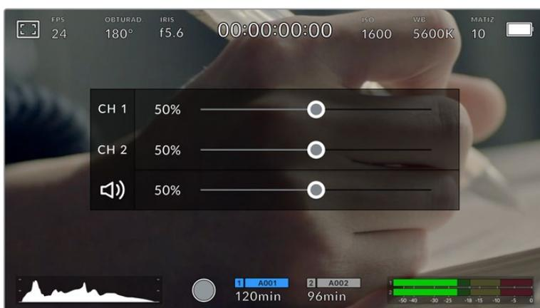
Toque nos medidores de áudio na tela de toque LCD para acessar o volume e as configurações de fone de ouvido ou alto-falante com facilidade.
