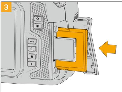
CFast 카드가 CFast 카드 슬롯에 제대로 장착될 때까지 집어넣습니다. 이 카드는 손쉽게 장착되어 무리하게 밀어 넣을 필요가 없습니다. 카드를 꺼내고 싶을 땐, CFast 카드를 살짝 누르면 카메라에서 CFast 카드가 분리되어 꺼낼 수 있습니다.
