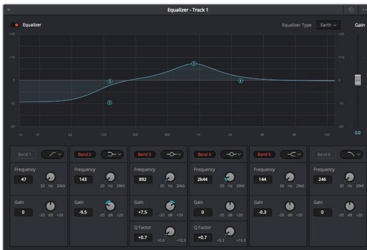
L'equalizzatore parametrico a 6 bande applicabile a ogni traccia
