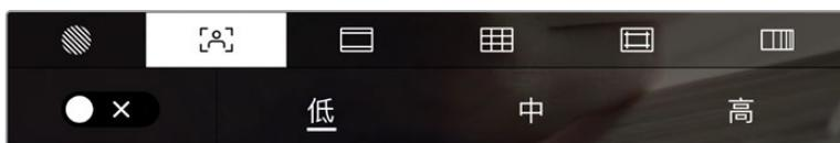
LCDモニターオプションでフォーカスアシストアイコンをタップして、カメラのフォーカスアシスト設定にアクセスします。
