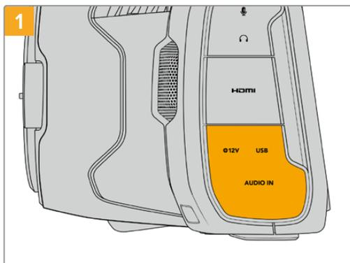
Ouvrez la protection en caoutchouc située sur le côté gauche de la caméra et connectez l'autre extrémité du câble au port USB-C.
