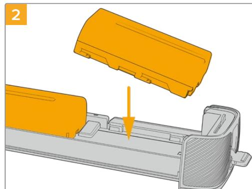
Coloque duas baterias NP-F570 na bandeja, tendo cuidado com a sua orientação, e deslize-as afastando uma da outra. Uma guia entre as baterias se desloca para travá-las no lugar. Quando quiser retirar as baterias, pressione esta guia de travamento e deslize as baterias em direção uma à outra.
