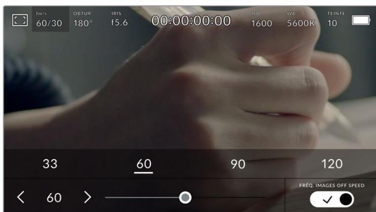
Lorsque la fonction **Fréq. images off speed** est activée, touchez un pré-réglage ou les flèches situées de part et d'autre de la fréquence d'images du capteur ou déplacez le curseur pour régler le paramètre.
