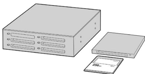
Для редактирования файлов непосредственно на карте CFast или SD извлеките ее из камеры и подключите к компьютеру, используя картридер CFast 2.0 или устройство CFast Drive
