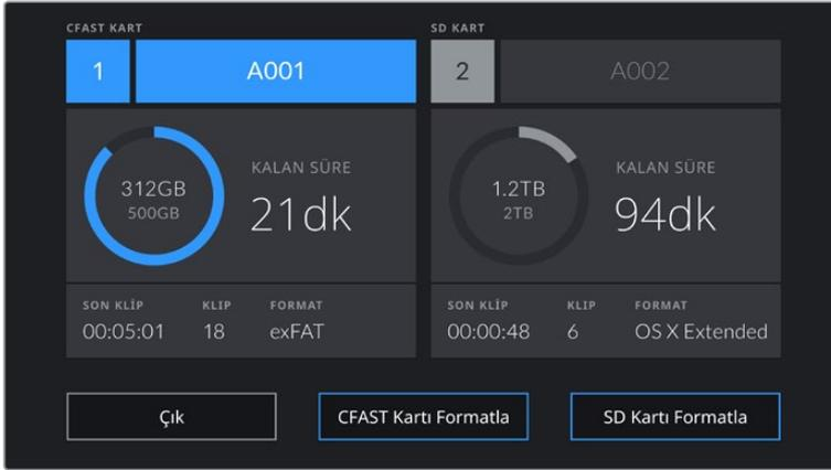
Depolama yöneticisine girmek için, dokunmatik LCD ekrandaki depolama göstergelerini tıklayın.
