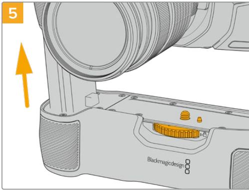
Kamera kulpunun batarya şeklindeki kısmını, kameranızın batarya yuvasına yerleştirin. Batarya kulpunun üstündeki 1/4 inçlik vida, kamera tabanındaki 1/4-20 montaj noktası ile hizaya gelmiş olması gerekir. 1/4 inçlik vidanın yanındaki küçük bir pim, hizanın doğru kalmasına yardımcı olur.
