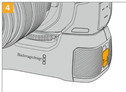
Gira la linguetta di blocco a lato dell'impugnatura in senso orario per bloccare il vassoio della batteria.
