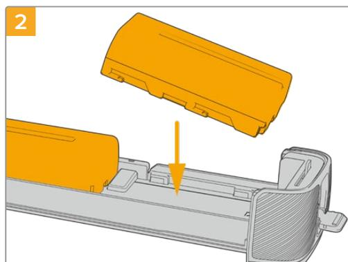
Поместите в лоток две батареи NP-F570, внимательно следя за правильностью установки и наличием между ними зазора. Снизу выдвинется фиксатор и закрепит их в нужном положении. Чтобы извлечь батареи, нажмите на фиксатор и подвиньте их друг к другу.
