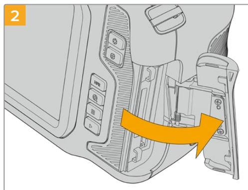
ドアにはスプリングが付いているので、固定が解除されると開きます。ここからCFastおよびSDメモリーカードのスロットにアクセスできます。
