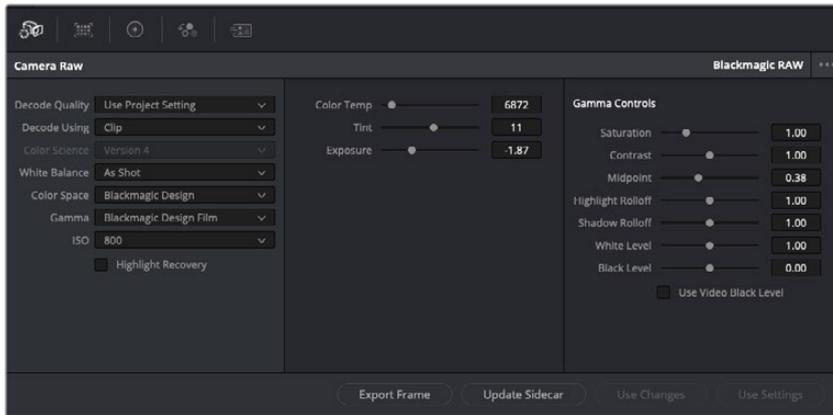
'Camera RAW' 탭에서 'Decoding Using'을 'Clip'으로 설정하면 사용하는 클립의 Blackmagic RAW 설정을 조절할 수 있습니다.
