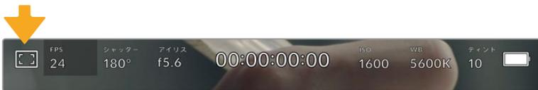
LCDタッチスクリーンの左上にあるアイコンをタップするとLCDモニター設定にアクセス可能
