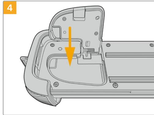
Klappen Sie die Akkufachabdeckung zu, damit sie mit der Unterseite des Akkueinschubs eine Ebene bildet.
