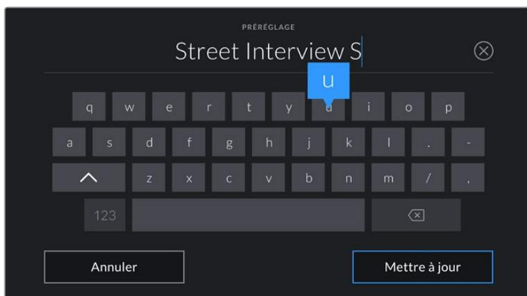
Saisissez un nom pour le préréglage à l'aide du clavier tactile en touchant l'icône **Ajouter** de l'onglet **Préréglages**.
