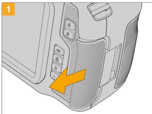
Pour accéder aux logements des supports de stockage, faites coulisser la porte située sur le côté arrière de la caméra.
