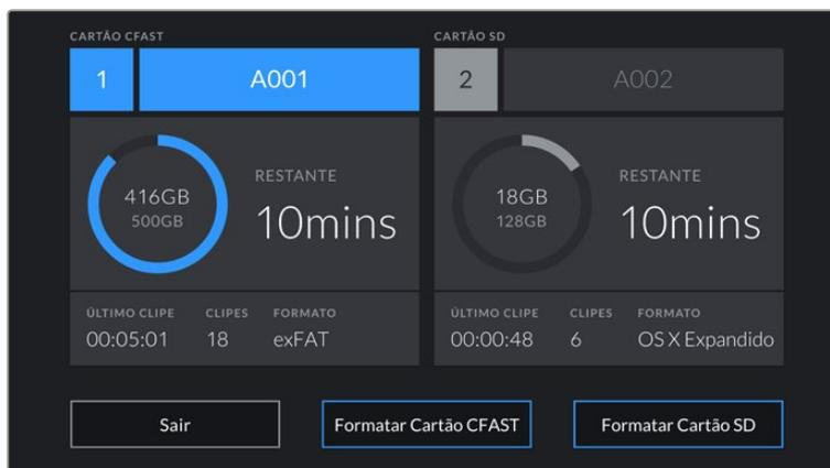
“Formatar Cartão SD” é substituído por “Formatar Disco Externo” na sua tela de armazenamento e formatação quando houver uma unidade flash USB-C conectada à sua câmera.
