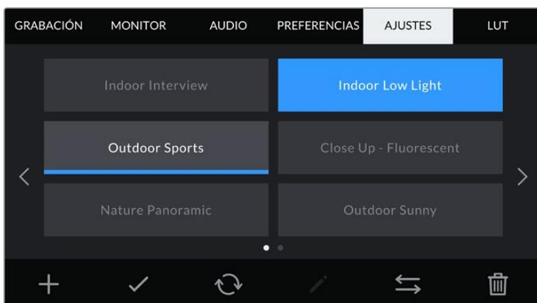
Elija una configuración predeterminada y pulse el ícono **Cargar** en la parte inferior de la pantalla para cargarla. Al seleccionar una configuración, el rectángulo con su nombre se destaca de color azul. Al cargarla, aparece una línea de dicho color en la parte inferior del mismo.
