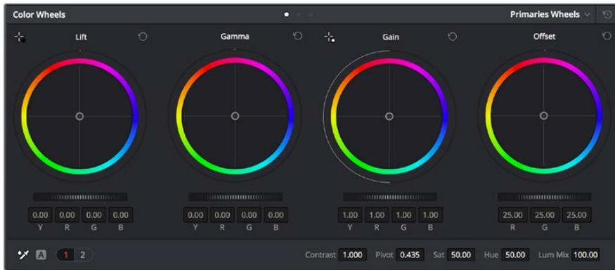
“暗部”、“中灰”、“亮部”、“偏移”色轮用于控制片段的色彩及色调平衡。拖动并来回滚动色轮下方的滚轮可对所有色彩的每种色调区域进行统一的调整。
