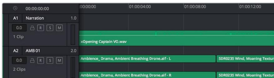
O cabeçalho de trilha A1 indica uma trilha mono como uma única pista para áudio mono, e o cabeçalho de trilha A2 indica uma trilha estéreo com duas pistas enquadrando o som estéreo.
