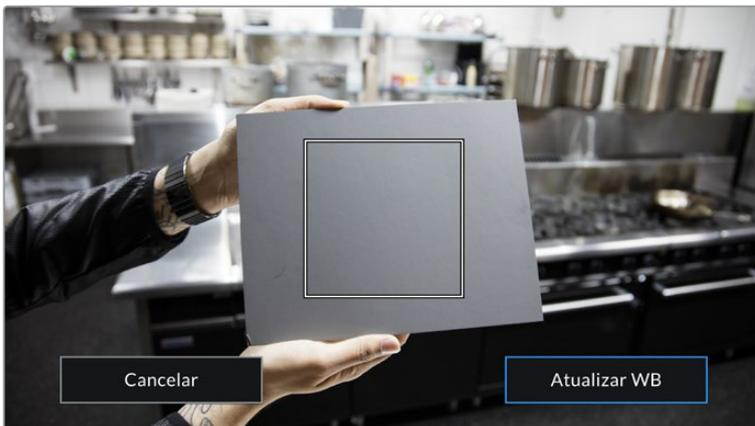
Tocar no ícone “AWB” no menu do balanço de branco ativará a tela para o balanço de branco automático. Utilize esta função com uma superfície branca ou cinza neutra para configurar um balanço de branco neutro automaticamente.
