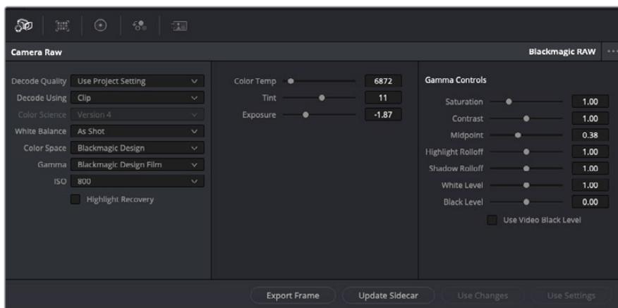
Dans l'onglet Caméra RAW, sélectionnez Plan dans le menu déroulant Dématricier avec pour régler les paramètres Blackmagic RAW des clips.
