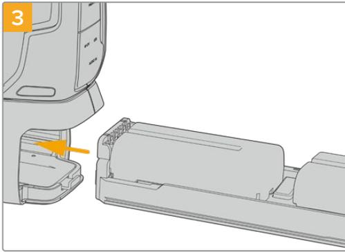
Deslize a bandeja de bateria no punho de bateria e gire a guia de travamento no sentido horário. É importante observar que você pode continuar gravando ao trocar as baterias no punho de bateria se a sua câmera estiver sendo alimentada por uma fonte externa conectada à entrada de alimentação DC.
