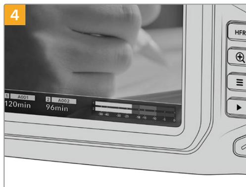
LCDタッチスクリーン底部のストレージ情報に、検出されたCFastカードの名前と録画可能時間が表示されます。
