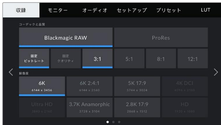
「収録 (RECORD)」、「モニター (MONITOR)」、「オーディオ (AUDIO)」、「セットアップ (SETUP)」、「プリセット (PRESETS)」、「ルックアップテーブル (LUTS)」のヘディングをタップしてPocket Cinema Cameraのダッシュボードタブを移動。
