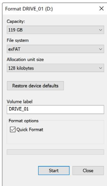
在Windows计算机上可使用“格式化”对话框将您摄影机的存储介质格式化为exFAT格式。
