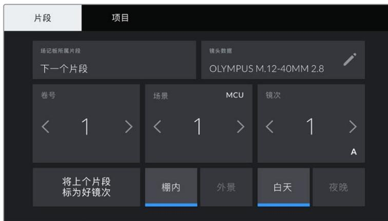
当摄影机在播放模式下时，“场记板所属片段”可识别场记板适用的片段，并显示“好镜次”按钮。在待命模式下时，场记板用于“下一个片段”，并显示“将上个片段标为好镜次”按钮。
