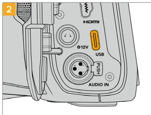
Соедините один конец USB-кабеля типа C с флеш-накопителем.
