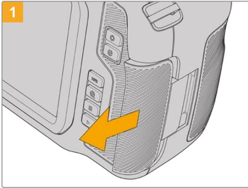
要找到存储卡槽, 首先滑动摄影机背面右侧的存储卡槽保护盖。
