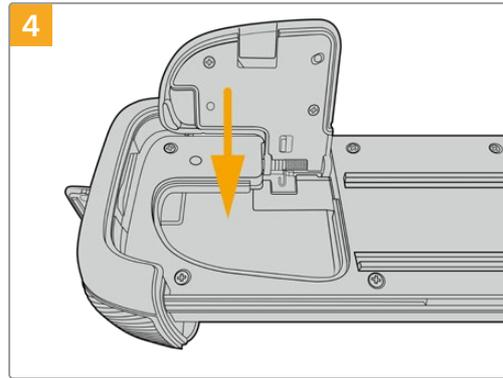
Refermez le couvercle du compartiment à batterie pour qu'il soit au même niveau que la face inférieure du support pour batterie.
