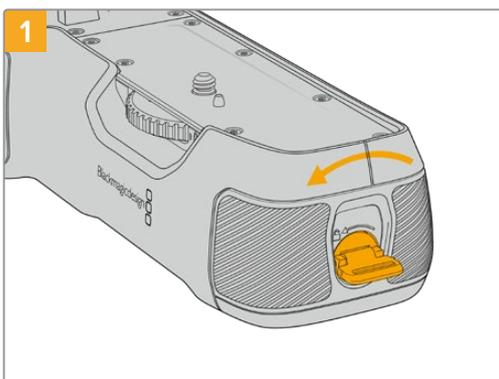
Поверните фиксатор сбоку рукоятки против часовой стрелки, чтобы разблокировать и вынуть батарейный лоток. Это можно сделать как до, так и после прикрепления рукоятки Blackmagic Pocket Battery Grip к камере.
