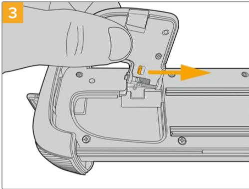
カバーの紛失を避けるため、Battery Gripのトレイ底面のくぼみにカバーを取り付けます。
