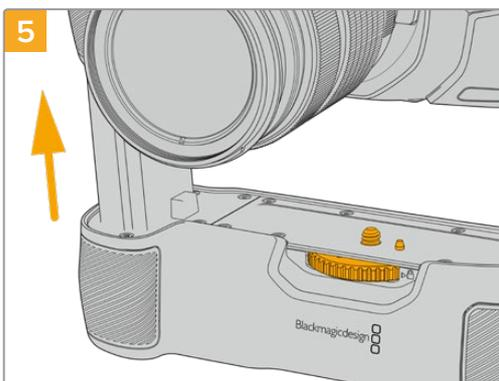
将手柄电池形状的部分插入摄影机的电池槽内。电池手柄顶部的1/4英寸螺丝应和摄影机底部的1/4-20安装孔对齐。1/4英寸螺丝一侧的小型定位销可有助于保持准确对齐。
