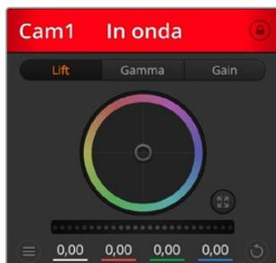
L'etichetta di ciascun canale si illumina di rosso se la rispettiva camera è in onda. I cerchi cromatici servono per regolare i parametri lift, gamma e gain per ogni canale YRGB.
