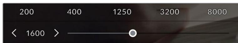
ISOメニューでは、カメラのLCDタッチスクリーン底部にISO設定が表示されます。プリセットの下のスライダーで、ISOを1/3段単位で調整できます。
