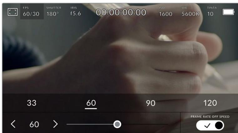
Abilita il frame rate del sensore e tocca i valori predefiniti o usa lo slider o le frecce per regolarlo
