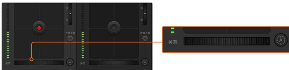
使用兼容镜头时，点击自动对焦按钮或左右拖动手动对焦控制可进行对焦。
