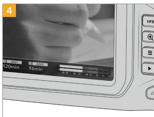
In basso al touchscreen appare il nome e la registrazione residua della scheda CFast rilevata.
