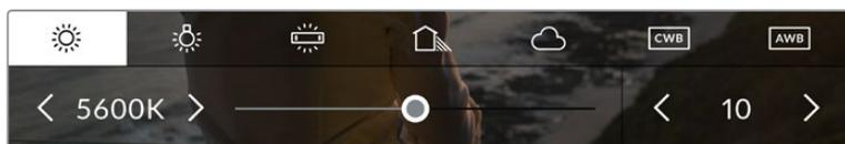
Com um toque no indicador de balanço de branco e de tonalidade, você terá acesso a cinco predefinições, além de um indicador de balanço de branco e um deslizador na esquerda e um indicador de tonalidade na direita. Seu ajuste definirá um balanço de branco personalizado para suas condições de iluminação.
