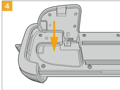
Cierre la tapa del compartimento, de forma que quede nivelada con la parte inferior de la empuñadura.
