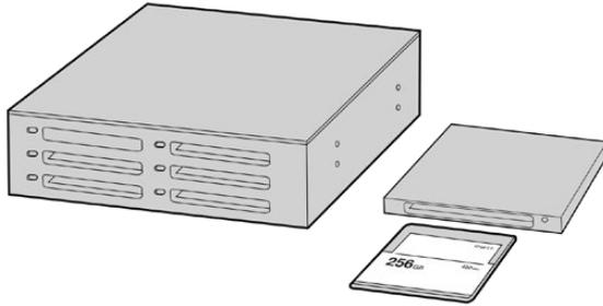
CFast/SDカードをカメラから取り出し、CFast 2.0リーダー/ライターまたはCFastドライブを使用してコンピューターにマウントすると直接編集できます。
