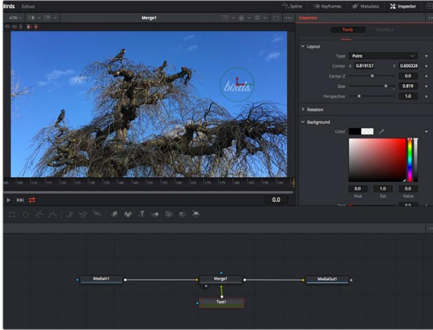
Seçili düğüm, kırmızı bir çerçeve ile görüntülenir. Burada denetleyici panel, metin/yazı düğümü için düzen sekmesi kontrollerini gösteriyor.
