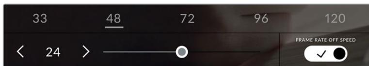
Abilita Frame Rate Off Speed e tocca le frecce o sposta lo slider per regolarlo
