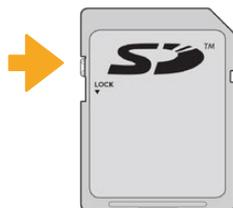
Чтобы установить или снять защиту от записи, передвиньте переключатель блокировки вниз или вверх
