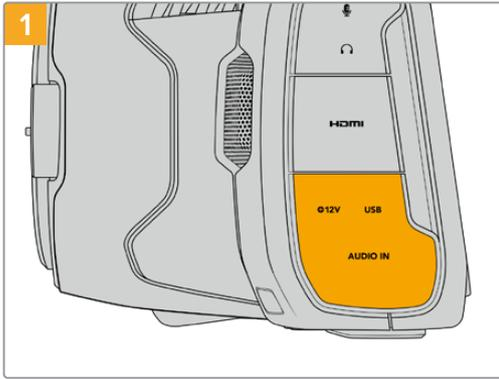
カメラの左側面のゴム製カバーを開き、ケーブルのもう一方の端をUSB-Cポートに接続します。
