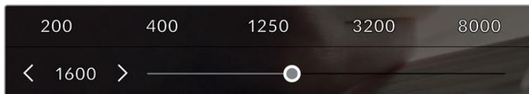
Dans le menu ISO de la caméra, ces paramètres apparaissent en bas de l'écran tactile. Le curseur permet d'incrémenter l'ISO d'1/3 de diaph.
