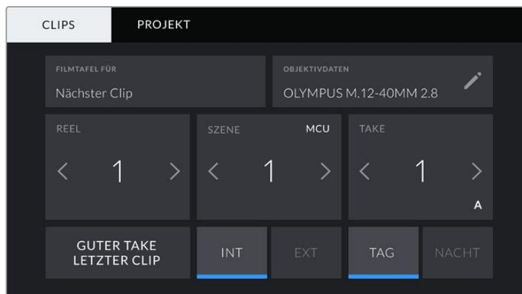
Im Wiedergabe-Modus erkennt FILMTAFEL FÜR die auf den Clip angewandte Slate und der GUTER TAKE-Button wird eingeblendet. Im Standby-Modus bezieht sich die Slate auf den nächsten Clip und der GUTER TAKE LETZTER CLIP-Button wird eingeblendet
