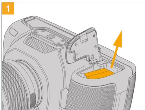
1 バッテリー収納部を開け、LP-E6バッテリーを取り出します。
