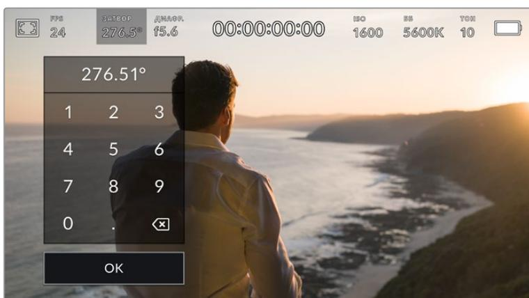
Цифровая клавиатура позволяет вручную установить угол раскрытия затвора при съемке вне павильона или использовании немерцающего освещения
