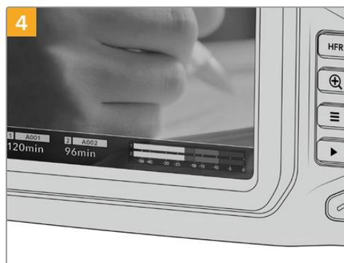
As informações de armazenamento na parte inferior da tela de toque LCD exibirão o nome e o tempo de gravação restante do cartão CFast detectado.
