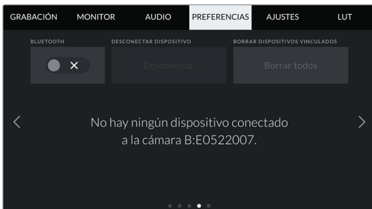
El nombre de la cámara está compuesto por la letra seleccionada en la claqueta virtual, seguida de un identificador de 8 caracteres.
