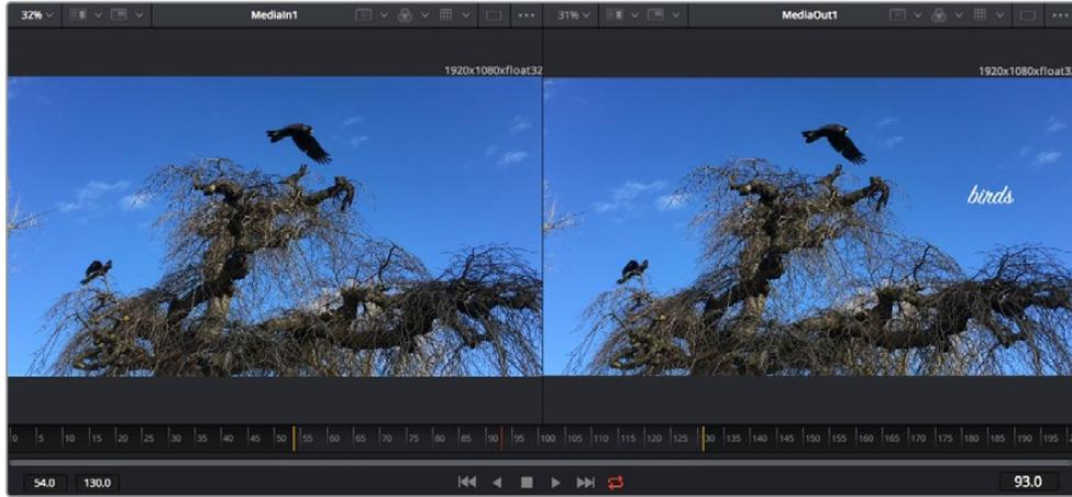
Zaman cetvelindeki sarı renkli işaretler, timeline'niz üzerinde klipinizin giriş ve çıkış noktalarını gösterir. Bir Fusion klipi veya bileşik klip kullanıyorsanız zaman cetveli sadece klipin timeline'de görüldüğü süreyi gösterecektir.
