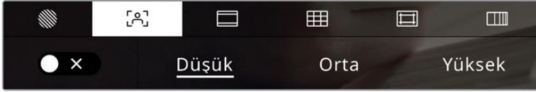
Kameranızın odak yardımı ayarlarına erişmek için, 'LCD ekran seçenekleri' sekmesindeyken 'odak yardımı' ikonunu tıklayın.
