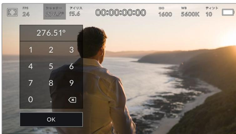
野外での撮影時、またはフリッカーの生じない照明下での撮影時に、マニュアル設定用のキーパッドを使ってシャッターアングルを入力。
