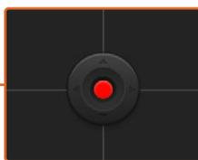
Когда сигнал камеры выводится в эфир, кнопка управления диафрагмой/уровнем черного становится красной
