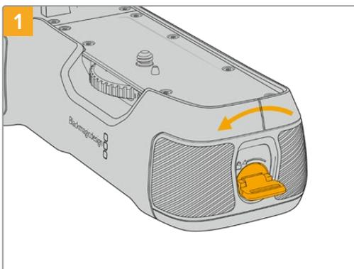
Gira la linguetta di blocco a lato dell'impugnatura in senso antiorario per sbloccare il vassoio della batteria. Estrai il vassoio della batteria. Questa operazione si può effettuare prima o dopo l'installazione di Blackmagic Pocket Battery Grip sulla camera.
