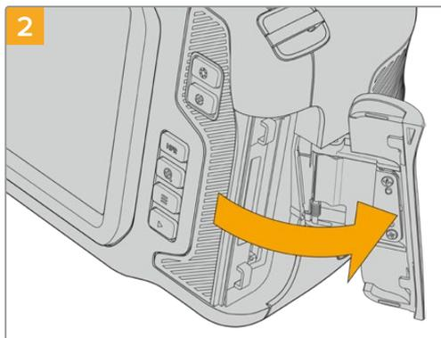
Подпружиненная крышка поднимется, открыв доступ к слотам карт SD и CFast.
