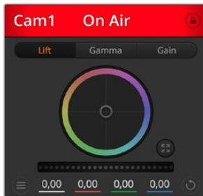
Die Kanalstatus-Box in jedem Kamerabedienfeld zeigt an, welche Kamera sich auf Sendung befindet. Justieren Sie anhand der Farbräder die Einstellungen von Lift, Gamma und Gain einzelner YRGB-Kanäle
