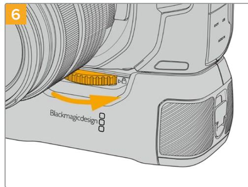
Gire o anel na frente do punho de bateria para a direita até que o parafuso esteja apertado firmemente e prenda o punho de bateria à câmera.
