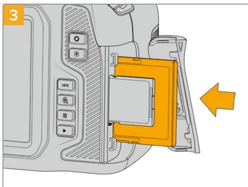
将CFast卡插入卡槽，直至锁定到位。无需过多外力即可插入存储卡。移除CFast卡时，只需向内轻推CFast卡即可将其释放并弹出。
