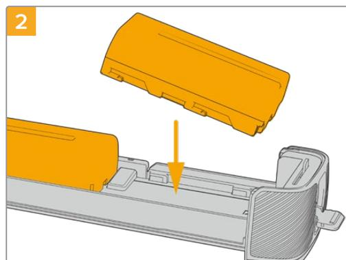
バッテリートレイに2個のNP-F570バッテリーを入れます。その際には、バッテリーの向きに注意してください。次に、バッテリーを外方向にスライドさせます。中央のタブが持ち上がり、バッテリーが正しい位置に固定されます。バッテリーを取り外すには、このタブを押し、バッテリーを内方向にスライドさせます。
