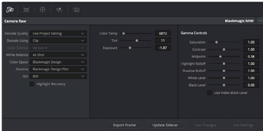
Na aba “Câmera Raw”, selecione “Clipe” a partir do menu suspenso “Decodificar Usando” para fazer ajustes nas configurações Blackmagic RAW do seu clipe.
