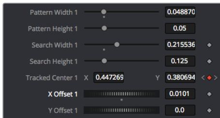
Turner les roues Offset en bas de la fenêtre de l'inspecteur permet d'ajuster la position du texte.
