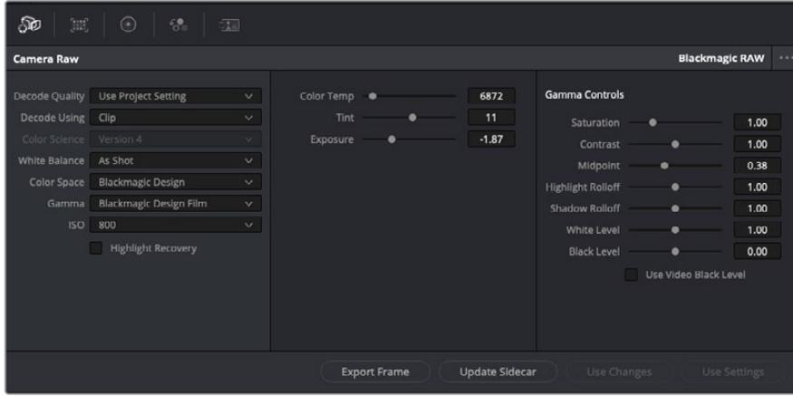
Klibinizin Blackmagic RAW ayarlarını düzenlemek için, 'camera raw' sekmesinde aşağıdaki 'decode using' (... ile kodu aç) menüsünden, 'clip' ibaresini seçin.
