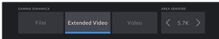
Le opzioni di gamma dinamica e area del sensore di Pocket Cinema Camera 6K
