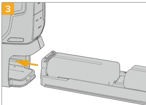
バッテリートレイをBattery Gripにスライドして挿入し、ロックタブを時計回りに回します。DC電源入力に外部電源ソースを接続して、カメラに給電している場合、バッテリーを充電しながらカメラで撮影を続けられます。
