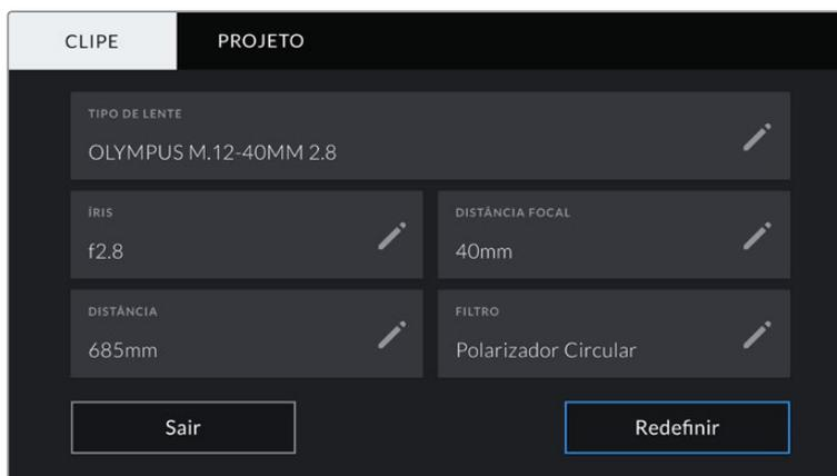
Menu “Dados da Lente” exibindo as informações populadas automaticamente de uma lente fixada e informações de filtro inseridas manualmente.
