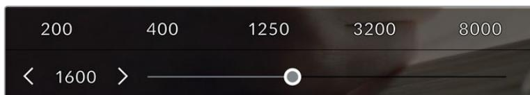
Las opciones disponibles para el valor ISO aparecen en la parte inferior de la pantalla. El control deslizante debajo de las opciones predeterminadas permite ajustar el valor ISO en incrementos de 1/3.
