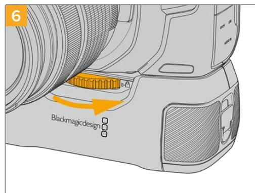
Um den Akkugriff sicher an der Kamera festzuschrauben, drehen Sie das Rad an der Vorderseite des Griffs nach rechts.
