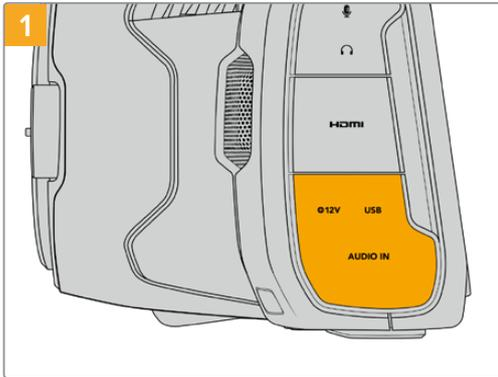
Öffnen Sie die Gummabdeckung auf der linken Seite der Kamera und stecken Sie das andere Ende des Kabels in den USB-C-Port.
