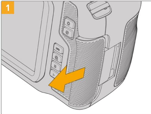
Für den Zugriff auf die Speicherkartenschächte schieben Sie die Abdeckung auf der rechten Kameraseite in Richtung Kamerarücken.
