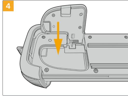
Feche a tampa do compartimento de bateria para que fique no mesmo nível da parte inferior da bandeja do punho de bateria.
