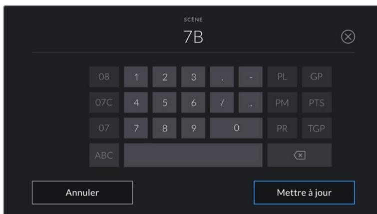
Lorsque vous saisissez les métadonnées de la scène, la caméra suggérera des numéros de scène sur le côté gauche du clavier tactile, et des types de plans sur le côté droit.
