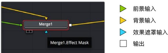
节点上有多个输出意味着单一节点能够连接合成中的许多不同节点, 所以与基于图层的软件不同, 您不需要复制片段。相连节点之间线上的箭头显示了图像数据流动的方向。
