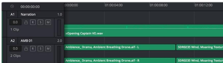
En el encabezado de la pista A1, se puede apreciar que es monoaural, mientras que las dos bandas de la pista A2 indican que es estereofónica.
