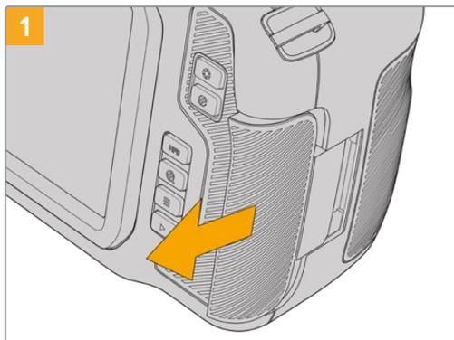
Para acceder a las ranuras de las unidades de almacenamiento, deslice la tapa del compartimiento en el lateral derecho hacia la parte trasera de la cámara.
