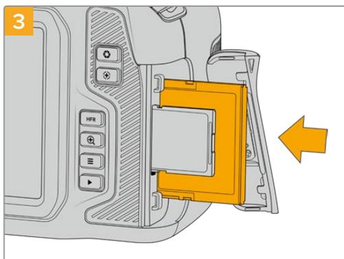
Inserte la tarjeta en la ranura correspondiente y empújela hasta que calce en su lugar. Para ello, no debería ser necesario ejercer demasiada fuerza. Si desea extraer una tarjeta SD de la cámara, empújela ligeramente y luego suéltela.
