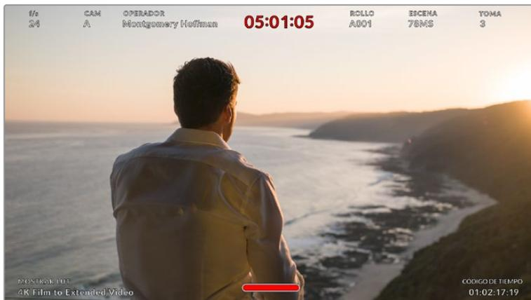
Los modelos Blackmagic Pocket Cinema Camera permiten ver datos útiles para el director en la imagen transmitida mediante la salida HDMI.
