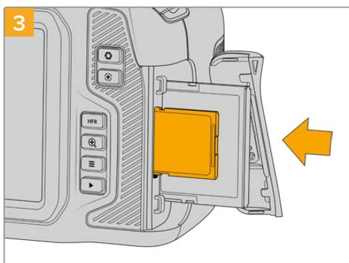
Inserte la tarjeta con la etiqueta orientada hacia la pantalla táctil y empújela hasta que calce en su lugar. Para ello, no debería ser necesario ejercer demasiada fuerza. Si desea extraer una tarjeta SD de la cámara, empújela ligeramente y luego suéltela.
