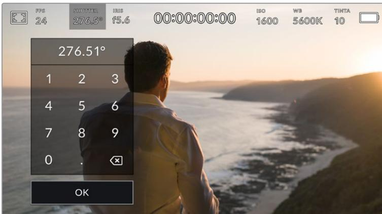
Utilizza la tastiera in sovrapposizione per inserire manualmente l'angolo dell'otturatore per le riprese in esterno e in presenza di luci senza sfarfallio
