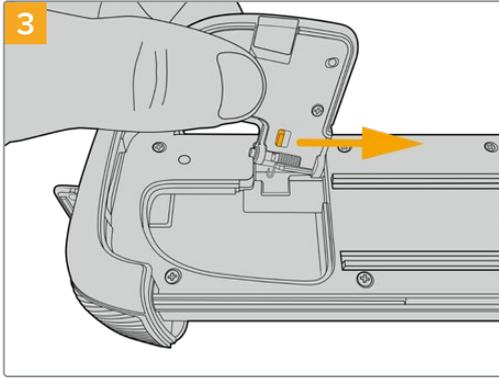
Para armazenamento seguro da tampa do compartimento de bateria, prenda-a à cavidade na parte de baixo da bandeja do punho de bateria.
