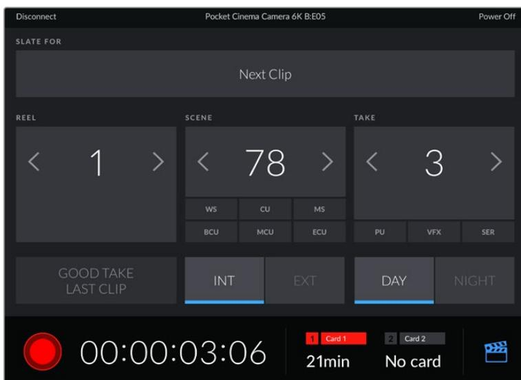
Touchez l'icône du clap dans le coin inférieur gauche pour accéder aux fonctions du clap et le mettre à jour.
