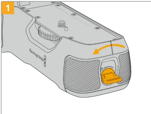
Batarya tepsisinin kilidini açmak için, batarya kulpunun ucundaki kilit halkasını saat yönü tersine çevirin. Batarya tepsisini kaydırarak çekip çıkartın. Bunu, Blackmagic Pocket Battery Grip'i kameranıza takmadan önce veya sonra yapabilirsiniz.
