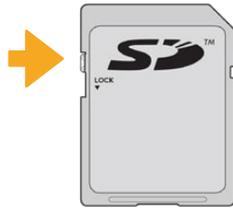
Mueva el interruptor hacia arriba o abajo para bloquear o desbloquear la tarjeta SD.
