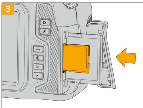
3 Возьмите карту SD таким образом, чтобы ее наклейка была обращена в сторону сенсорного экрана, и вставьте в слот до конца. Она должна свободно войти внутрь без приложения излишней силы. Для извлечения накопителя осторожно нажмите на карту SD и отпустите, чтобы она вышла из отсека.
