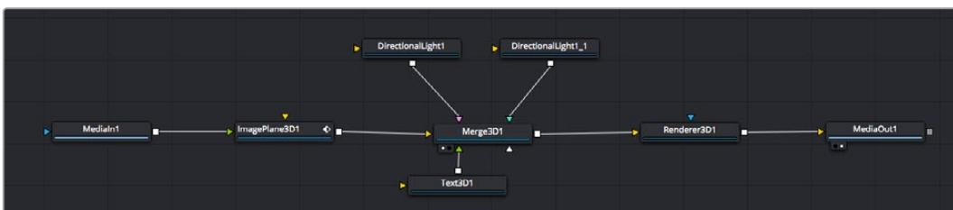
Наиболее часто используют инструмент объединения Merge 2D или Merge 3D. Он выполняет роль центрального элемента, с помощью которого формируется единое изображение на выходе.
