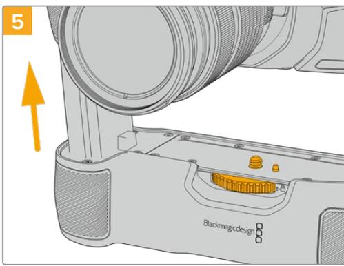
Inserisci la parte dell'impugnatura con la forma della batteria nell'alloggiamento della batteria. La vite di 1/4" sulla parte superiore dell'impugnatura deve essere allineata al foro filettato di 1/4"-20 alla base della camera. Un piccolo pin di riferimento vicino alla vite di 1/4" aiuta a mantenere il corretto allineamento.
