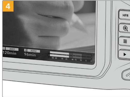
Dokunmatik LCD ekranın altındaki depolama bilgileri, tespit edilen CFast kartın adını ve kalan kayıt süresini gösterecektir.
