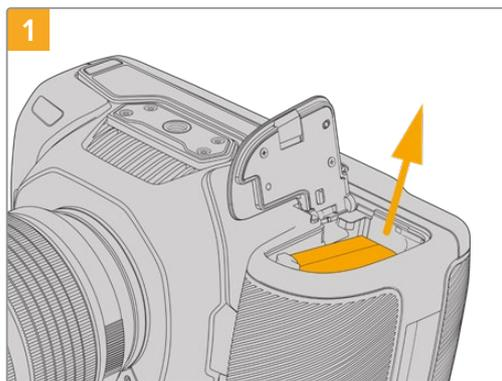
Ouvrez le compartiment à batterie de la caméra et retirez la batterie LP-E6.
