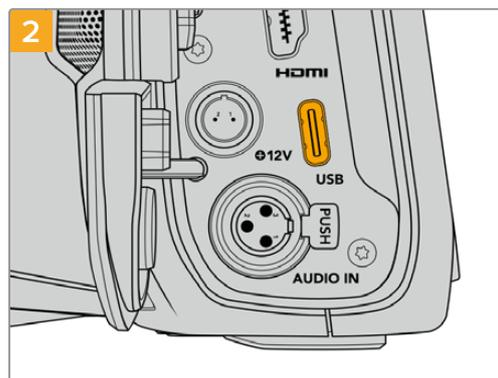
Conecte uma extremidade do cabo USB tipo C à sua unidade flash USB-C.
