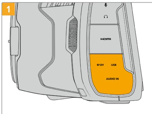
С левой стороны камеры откройте защитную резиновую накладку и соедините другой конец кабеля с портом USB-C.
