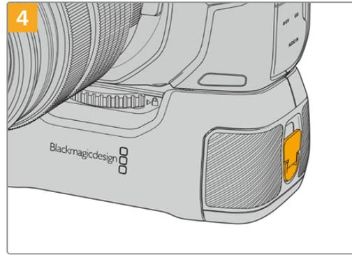
Gire a guia de travamento na ponta do punho de bateria no sentido horário para travar a bandeja de bateria.
