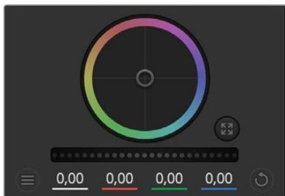
Ajustez les roues maîtresses en déplaçant la commande vers la gauche ou vers la droite.
