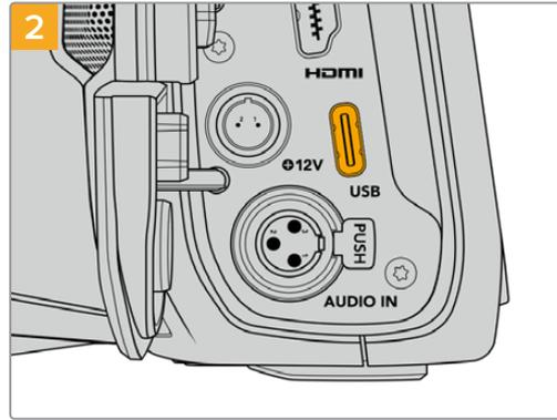
USBタイプCケーブルの一端をUSB-Cフラッシュディスクに接続します。
