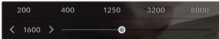
Bei geöffnetem ISO-Menü erscheinen die ISO-Einstellungen Ihrer Kamera am unteren Rand des LCD-Touchscreens. Mit dem Schieberegler unter den Presets können Sie den ISO-Wert in Drittel-Blendenstufen anpassen
