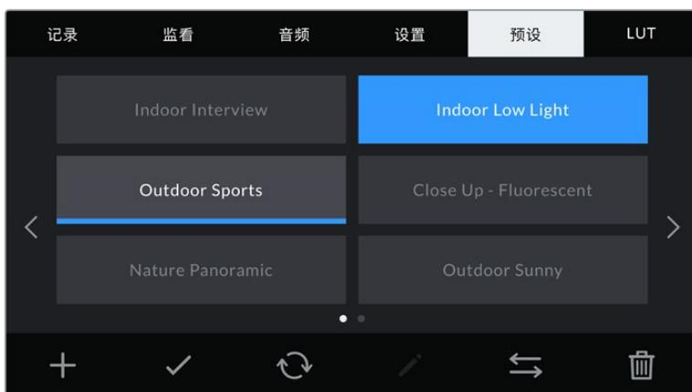
选择一个预设，并点按表示“加载”的图标来加载这一预设。选中的预设将以纯蓝背景显示，当前加载的预设则会在其对应的图标底部标以蓝色横线。
