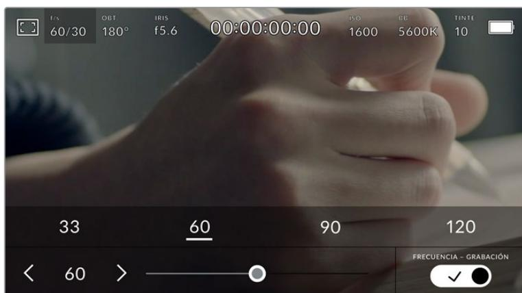
Si la opción **FRECUENCIA - GRABACIÓN** está activada, pulse un ajuste o las flechas situadas a ambos lados del valor correspondiente a la frecuencia de imagen o mueva el control deslizante para realizar ajustes.
