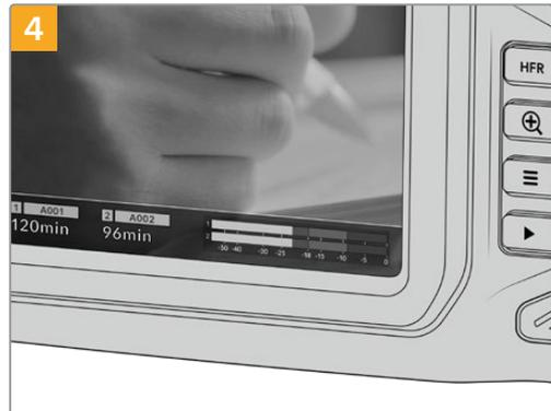
LCDタッチスクリーン底部のストレージ情報に、検出されたSDカードの名前と録画可能時間が表示されます。
