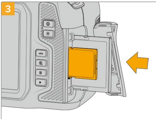
将SD卡的标签朝向触摸屏插入SD卡槽, 直至锁定到位。无需过多外力即可插入存储卡。
