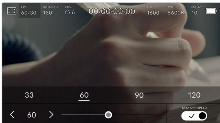
Com o recurso “Taxa Off-Speed” habilitado, toque nas setas em qualquer uma das laterais da taxa de quadro do sensor ou mova o deslizador para fazer ajustes.
