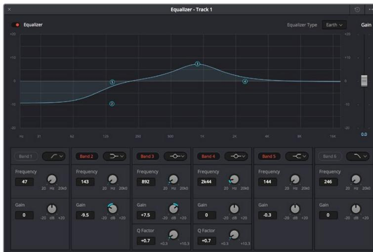
Каждую дорожку можно обработать с помощью шестиполосного параметрического эквалайзера
