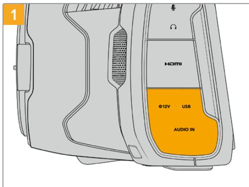
Abra la tapa protectora de goma en el lateral izquierdo de la cámara y conecte el otro extremo del cable al puerto USB-C.
