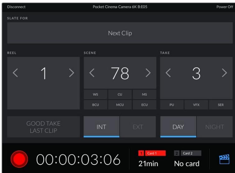
Tippen Sie auf das Filmklappen-Icon unten rechts, um auf die Slate zuzugreifen und sie zu aktualisieren
