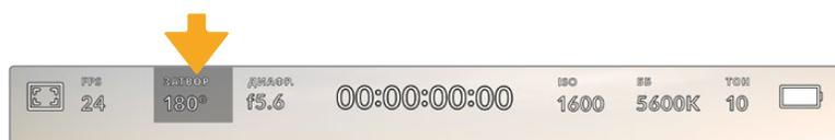
Для доступа к настройкам затвора коснитесь соответствующего индикатора
