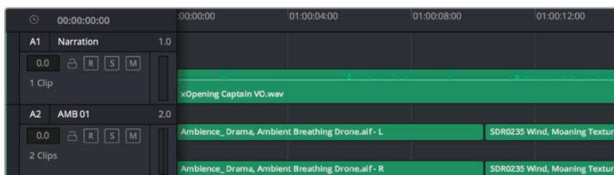
Der Spur-Header von Spur A1 verweist auf eine Monospur mit einer einzelnen Unterspur für Monoton. Bei Spur A2 hingegen handelt es sich um eine Stereospur für Stereoton
