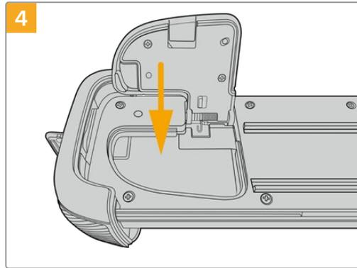
关闭电池槽保护盖, 使其平整卡入并固定在电池手柄槽内部设计的凹槽。
