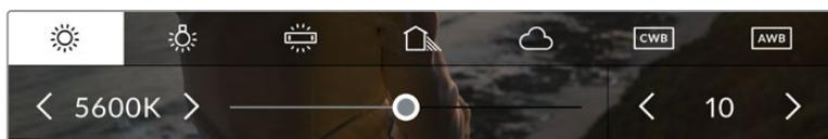
点按白平衡和色调提示可让您获得五种预设，以及左侧的白平衡提示和滑块，和右侧的色调提示。请根据不同的照明条件来调整自定义白平衡设置。
