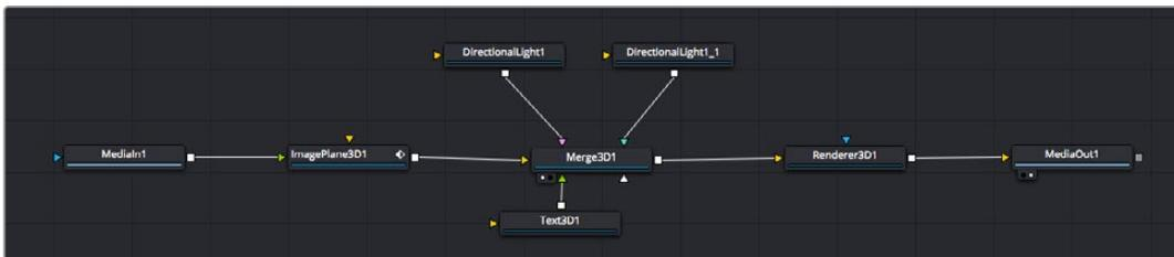
Der 2D- oder 3D-Merge-Node ist das am häufigsten verwendete Tool. Dieser Node fungiert als Drehscheibe, die Tools im Node-Editor in einen einzelnen Ausgang zusammenführt.
