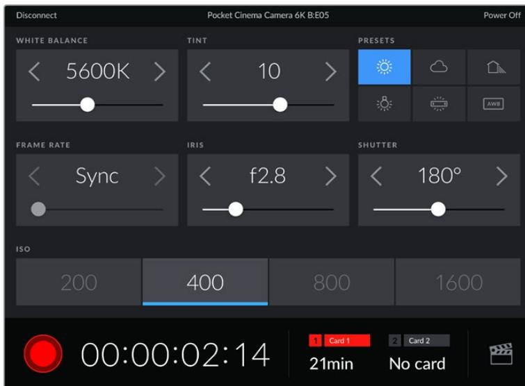
После установки соединения приложение Blackmagic Camera Control позволяет менять настройки и запускать запись
