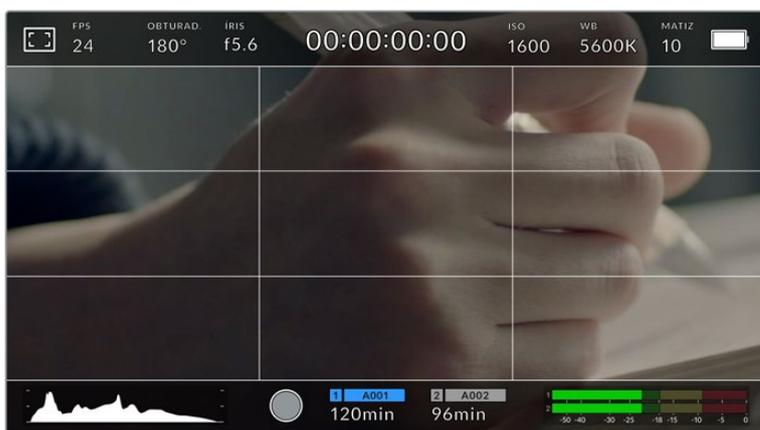
A grade de regra dos terços se redimensiona automaticamente para qualquer guia de enquadramento na tela.
