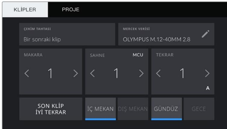
Kamera 'oynatma' modundayken, 'çekim tahtası' sekmesi, çekim tahtasının kapsadığı klibi tanımlar ve 'iyi tekrar' butonunu gösterir. 'Bekleme' modunda, çekim tahtası bir sonraki klip içindir ve 'en son klip iyi çekim' butonunu gösterir.
