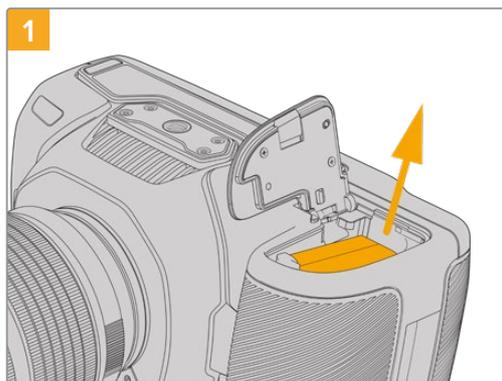
1 Abra el compartimiento para la batería de la cámara y retire la batería LP-E6.
