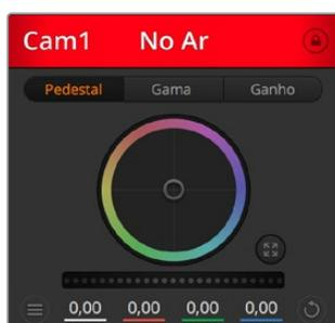
Cada controlador de câmera exibe o status do canal, assim você sabe qual câmera está no ar. Use os discos de cores para ajustar as configurações de pedestal, gama e ganho de cada canal YRGB.
