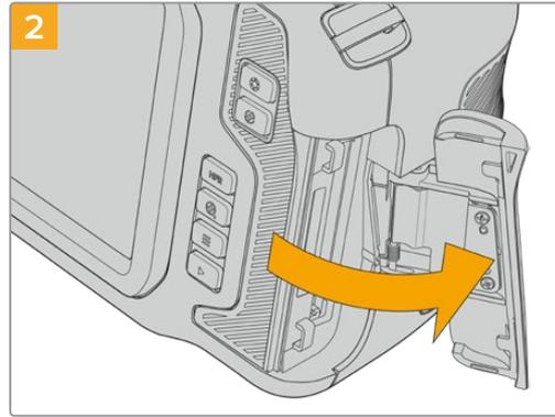
弹簧门会顺势打开, 露出存储介质卡槽。
