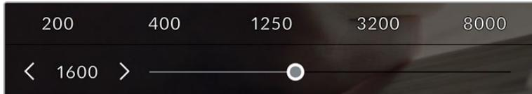
进入ISO菜单后，LCD触摸屏的下方会显示摄影机的ISO设置。预设下方的滑块能以1/3挡的增量调整ISO。
