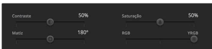
Arraste os deslizadores para a esquerda ou direita para ajustar as configurações de contraste, saturação, matiz e lum mix.
