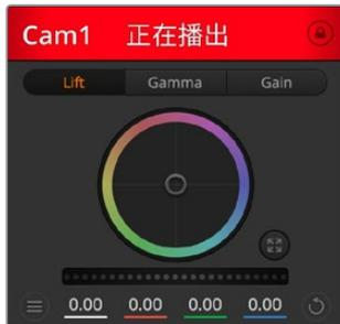
每个摄影机控制窗口都会显示通道状态，以便您明确当前哪台摄影机正处于播出状态。使用色轮来调整每个YRGB通道的Lift、Gamma和Gain设置。
