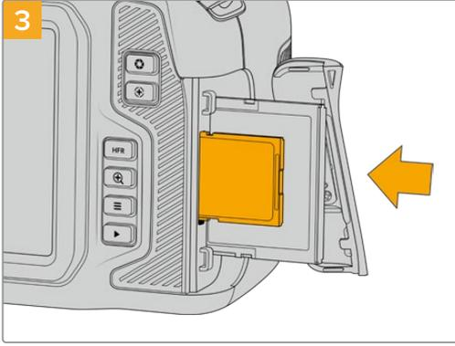
SD kartın üzerindeki etiket dokunmatik ekrana dönük olarak, yerine kilitlendiğine emin olana kadar, SD kartı yuvasına itin. Kartın, zorlamaya gerek kalmadan, kolaylıkla yerleşmesi gerekir. Bir SD kartı çıkarmak için, SD kartı yavaşça kameraya doğru içeri itin ve sonra çıkarmak için serbest bırakın.
