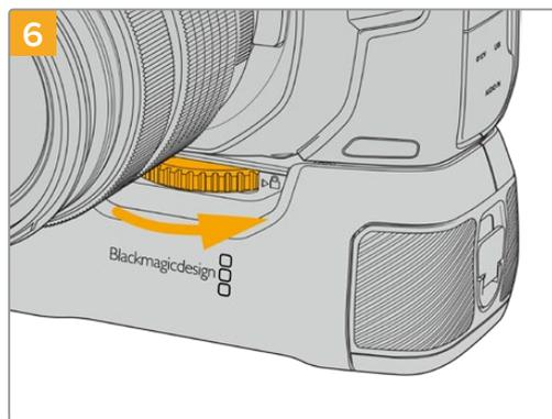
Gire la rueda en la parte frontal de la empuñadura hacia la derecha a fin de apretar el tornillo y sujetarla a la cámara.
