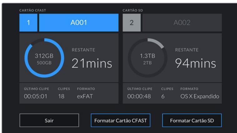
Toque nos indicadores de armazenamento no LCD da tela de toque para acessar o gerenciador de armazenamento.
