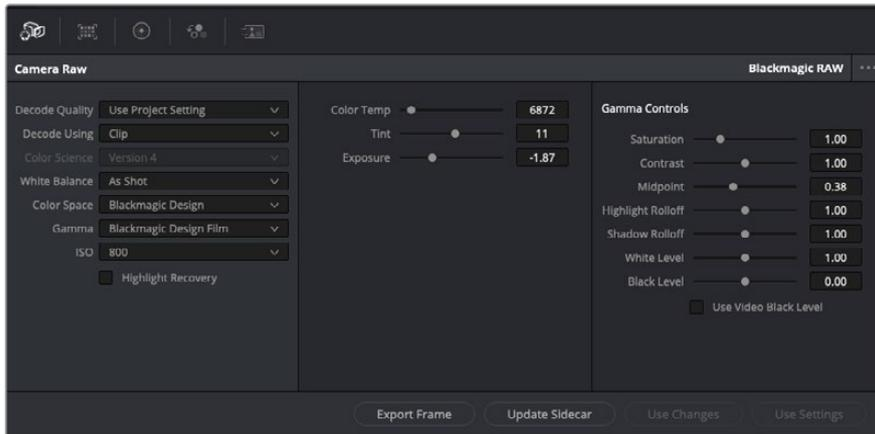
在“Camera Raw”选项卡中，从“解码方式”下拉菜单中选择“片段”，可调整单个片段的Blackmagic RAW设置。
