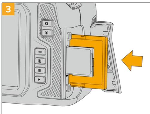
CFastカードが固定されるまで、カードをCFastスロットに差し込みます。カードは、過度に力を入れる必要なく簡単に挿入できるはずですが、CFastカードを取り出すには、CFastカードをゆっくり押し離すとイジェクトされます。
