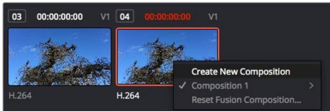
新しいバージョンの合成を作成するには、サムネイルを右クリックして「新規コンポジションを作成」を選択します。
