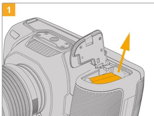
1 Apri lo sportellino dell'alloggiamento della batteria e rimuovi la batteria LP-E6.
