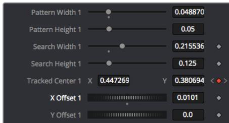
Die Scrollräder unten im Tracker-Fenster des Inspectors dienen zum Anpassen der Offset-Platzierung von Text
