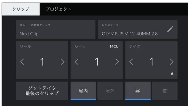
カメラが再生モードの場合、「スレートの対象クリップ (SLATE FOR)」には操作が適用されるクリップが表示され、「グッドテイク (GOOD TAKE)」ボタンが表示されます。スタンバイモードの場合、「スレートの対象クリップ (SLATE FOR)」は次のクリップになり、「グッドテイク - 最後のクリップ (GOOD TAKE LAST CLIP)」ボタンが表示されます。
