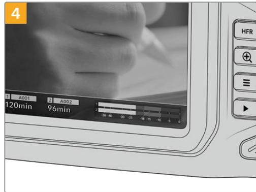
4 LCD 터치스크린 하단에 나타나는 저장 정보를 통해, 사용 중인 SD 카드의 이름 및 잔여 녹화 시간을 확인할 수 있습니다.
