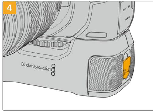
Tournez la languette de verrouillage de la poignée dans le sens des aiguilles d'une montre pour déverrouiller le support pour batterie.
