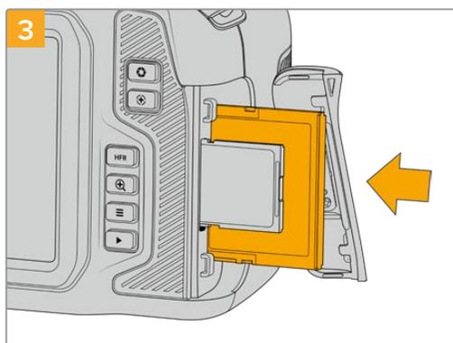
Insira o cartão CFast no compartimento para cartão CFast até senti-lo travar no lugar. O cartão deve ser inserido com facilidade, sem necessidade de força excessiva. Para remover um cartão CFast, pressione-o suavemente e depois solte para ejetá-lo.
