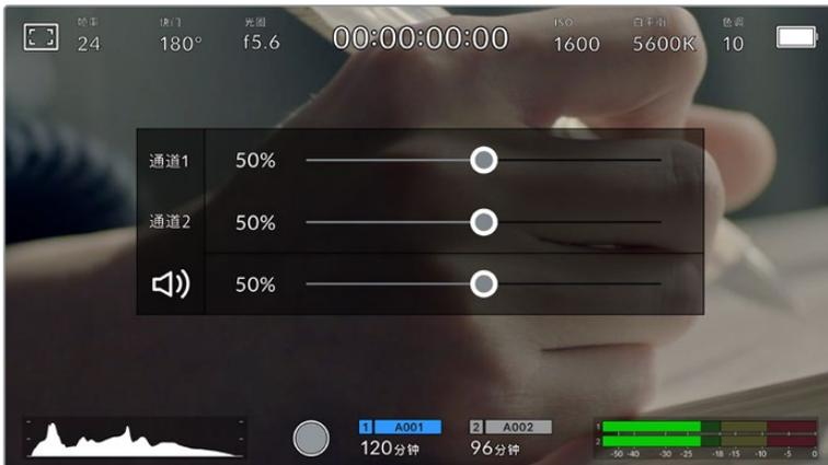
在LCD触摸屏上点按音频表可轻松进入音量和耳机或扬声器设置。
