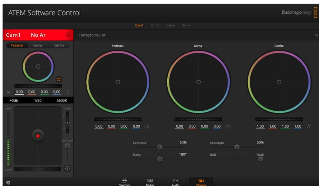
Clique no botão do corretor primário de cores DaVinci Resolve para ampliar a janela de correção de cores e fazer ajustes.
