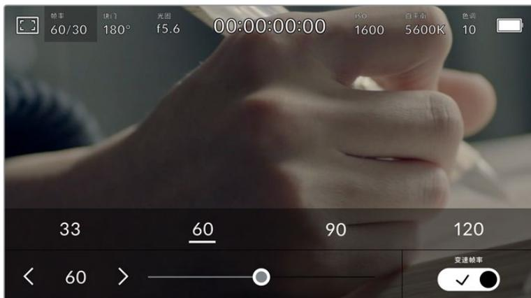
启用“变速帧率”选项后，点按某个预设或传感器帧率两侧的箭头图标，或者移动滑块就可进行调整。
