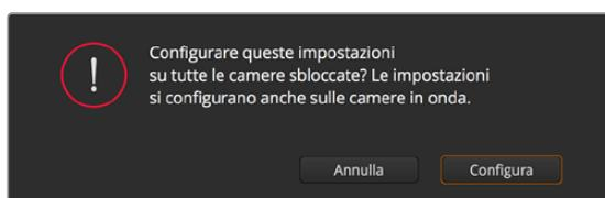
Un messaggio di conferma chiede se applicare i parametri a tutte le camere per evitare di alterare accidentalmente i parametri delle camere in onda non bloccate.
