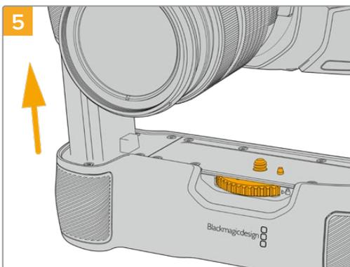
Insérez la partie verticale de la poignée dans le compartiment à batterie de la caméra. La vis de 1/4 de pouce sur le haut de la poignée doit s'aligner avec le pas de vis 1/4-20 de la caméra. Une petite broche située à côté de la vis de 1/4 de pouce aide à conserver un bon alignement.
