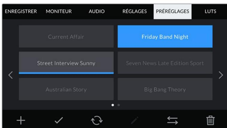
Sélectionnez un préréglage et touchez l'icône **Charger** pour le charger. Les préréglages sélectionnés s'affichent en bleu, tandis que les préréglages chargés sont soulignés en bleu.
