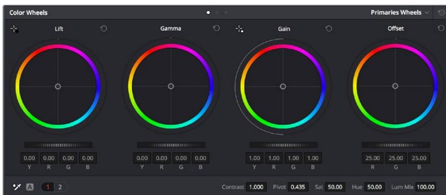
Los círculos cromáticos permiten controlar con precisión el balance de colores y los tonos en los distintos clips. Para ajustar cada área tonal en forma similar, deslice el dial situado debajo de los círculos cromáticos hacia la izquierda o la derecha
