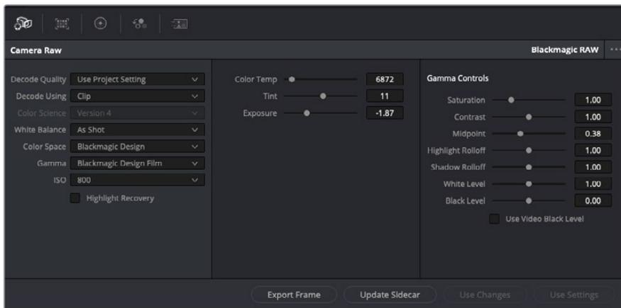
Чтобы изменить настройки Blackmagic RAW для отдельного клипа, выберите «Клип» в раскрывающемся меню «Для декодирования использовать» на вкладке «Настройки RAW камеры»
