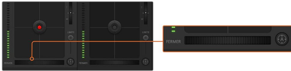
Cliquez sur le bouton de mise au point automatique ou déplacez le curseur de mise au point manuelle vers la gauche ou vers la droite pour effectuer la mise au point d'un objectif compatible.
