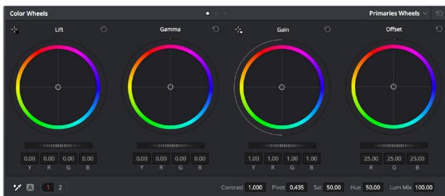
I cerchi cromatici di Lift, Gamma, Gain e Offset consentono di creare il colore ottimale per bilanciare i toni del colore delle clip. Per regolare in maniera uniforme tutti i colori per ogni tono, muovi opportunamente le rotelle sotto i cerchi cromatici
