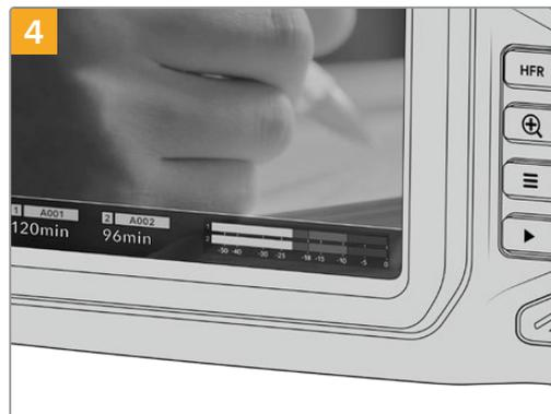
LCD 터치스크린 하단에 나타나는 저장 정보를 통해 사용 중인 CFast 카드 이름 및 잔여 녹화 시간을 확인할 수 있습니다.
