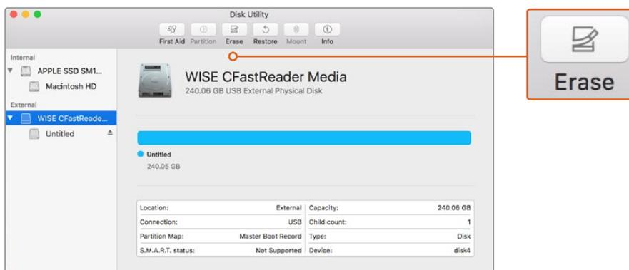
El programa Utilidad de Discos, incluido en el sistema operativo macOS, permite formatear soportes de almacenamiento mediante el sistema HFS+ o exFAT. Antes de comenzar, asegúrese de respaldar cualquier información importante que contenga la unidad, ya que, al iniciar el proceso, se borrarán todos los datos.
