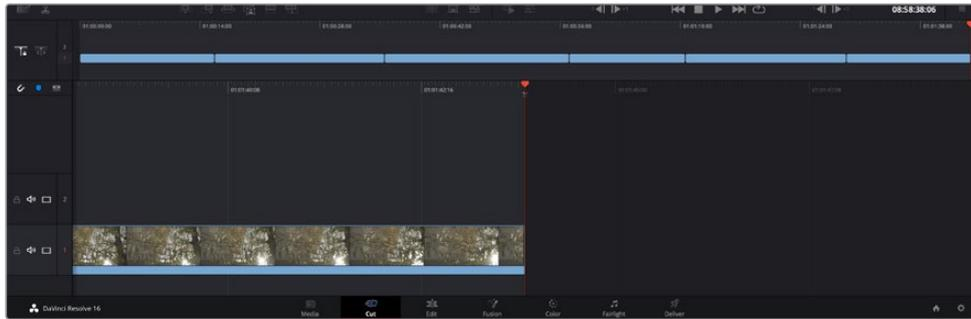
La función **Agregar clips** permite asegurarse de que no hay espacios vacíos en la línea de tiempo.
