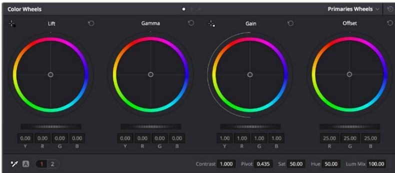
'Lift', 'gamma', 'gain' ve 'offset' renk tekerleri, kliplerinizin renk ve tonlama dengesi üzerinde tam kontrol sağlar. Her bir tonlama bölgesi için renklerin tümüne aynı ayarlamayı yapmak üzere, renk tekerlerinin altında bulunan kadrani, ileri ve geri sürükleyin.
