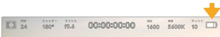
バッテリー電源を使用している場合、電源インジケータをタップすると表示が切り替わります。
