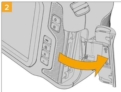
弹簧门会顺势打开，露出CFast和SD存储卡槽。
