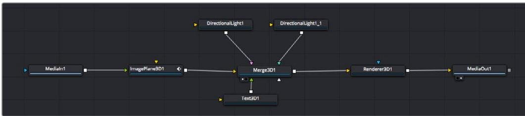
La herramienta empleada con mayor frecuencia es el nodo de combinación 2D o 3D. Este combina diversas herramientas del editor en una sola salida.
