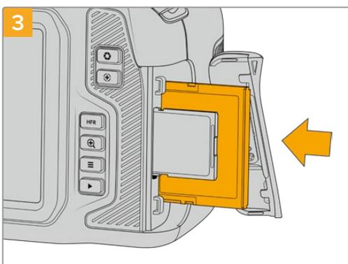
Schieben Sie die CFast-Karte in den dafür vorgesehenen Schacht, bis sie spürbar einrastet. Die Karte sollte sich ohne übermäßigen Kraftaufwand einführen lassen. Um die CFast-Karte zu entfernen und auszuwerfen, schieben Sie sie sanft in die Kamera.
