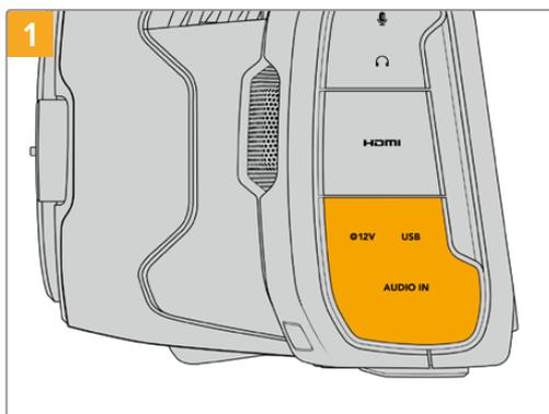
Abra o protetor emborrachado na lateral esquerda da câmera e conecte a outra extremidade do cabo à porta USB-C.
