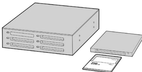
Schneiden Sie direkt von Ihrer CFast- oder SD-Karte, indem Sie sie aus Ihrer Kamera entnehmen und über ein CFast-2.0-Lese-/Schreibgerät oder CFast-Laufwerk an Ihren Computer anschließen
