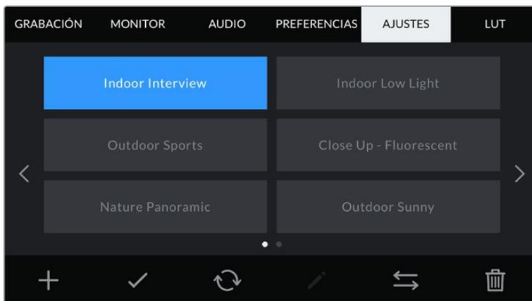
La pestaña **AJUSTES** permite alternar rápidamente entre distintas configuraciones almacenadas en la cámara.
