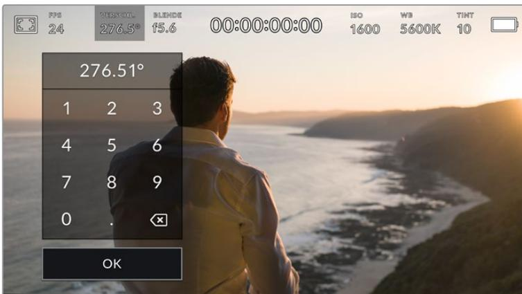
Geben Sie den Verschlusswinkel manuell über die kleine Tastatur ein, wenn Sie im Freien oder bei flimmerfreiem Licht drehen
