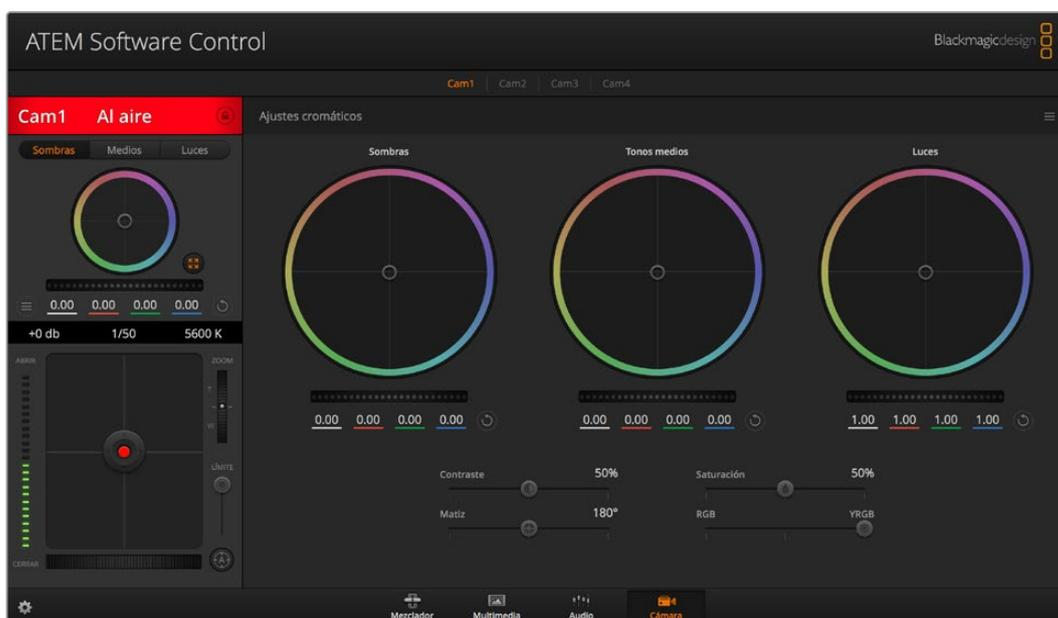
Si desea acceder a las herramientas para correcciones primarias de DaVinci Resolve, haga clic sobre el botón situado en la parte inferior, a la derecha del círculo cromático.
