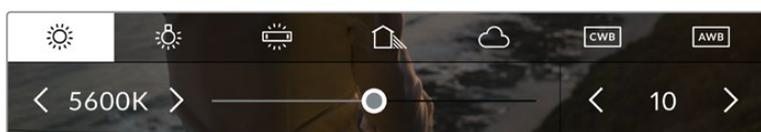
Al pulsar los indicadores **BB** y **TINTE**, es posible acceder a cinco configuraciones predeterminadas o modificar estos parámetros en forma individual. Realice los ajustes necesarios según las condiciones de iluminación.
