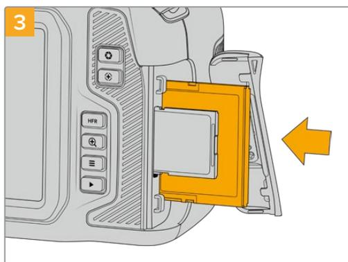
Insérez la carte CFast dans le logement pour carte CFast jusqu'à ce qu'elle s'enclenche. La carte doit pouvoir s'insérer aisément et sans forcer. Pour retirer une carte CFast, appuyez délicatement dessus, puis relâchez pour l'éjecter.
