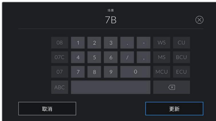
输入“场景”元数据时,摄影机的屏幕键盘左侧会提供场景号建议,右侧会提供拍摄镜头类型。
