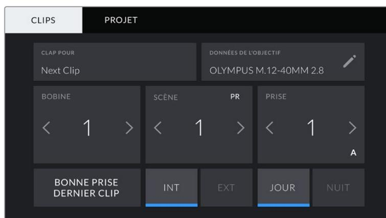
En mode lecture, le champ **Clap pour** identifie le clip auquel se réfère le clap et le bouton **Bonne prise** est visible. En mode veille, le clap se réfère au **Next clip** (prochain clip) et le bouton **Bonne prise dernier clip** est visible.
