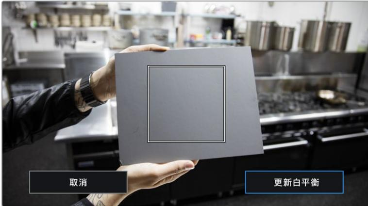
在白平衡菜单中点按“AWB”图标，可调出自动白平衡设置界面。将界面中的方框对准白色或中性灰色表面来自动设置一个中性白平衡。
