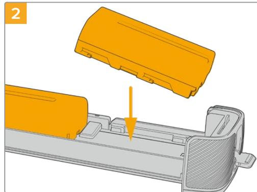
İki adet NP-F570 bataryayı, yönlerine dikkat ederek ve birbirinden ayrı olacak şekilde batarya tepsisine yerleştirin. Bataryaları yerlerine kilitlemek için bataryaların arasında yukarı hareket eden bir tırnak vardır. Bataryaları çıkarmak istediğinizde, bu tırnağı aşağı doğru bastırın ve bataryaları birbirlerine doğru kaydırın.
