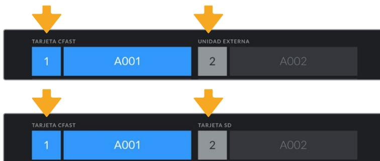
El tipo de soporte de grabación utilizado se indica en la pantalla de la cámara.
