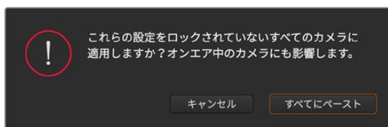
「すべてにペースト」を適用する際は、操作を確認する注意メッセージが表示されます。このメッセージは、現在オンエア中でロックされていないカメラに、誤って新しい設定をペーストすることを避けるために表示されます。
