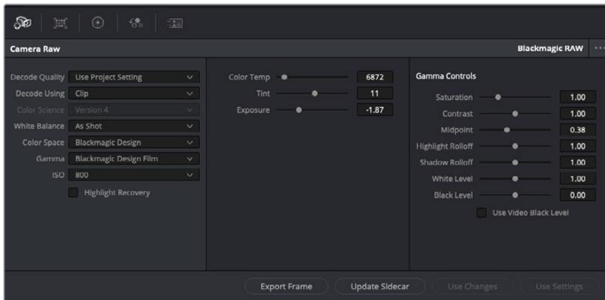
Um Anpassungen an den Blackmagic-RAW-Einstellungen Ihres Clips vorzunehmen, wählen Sie im „Camera Raw“-Tab aus dem Drop-down-Menü „Decode Using“ (Dekodieren mit) die Option „Clip“ aus
