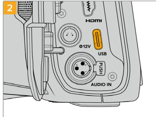
Stecken Sie ein Ende des USB-C-Kabels in Ihr USB-C-Laufwerk.
