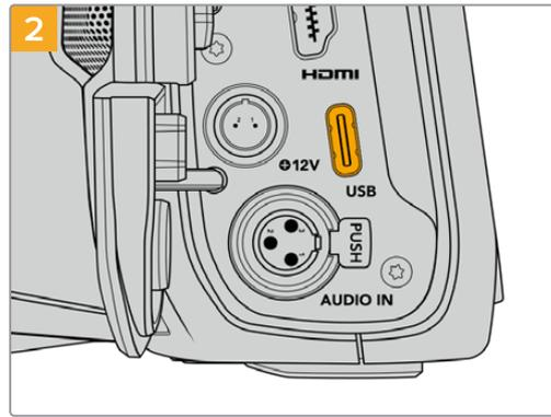
将USB-C类线缆的一端连接到您的USB-C硬盘上。
