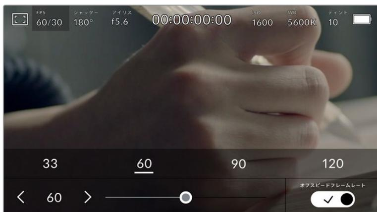
「オフスピードフレームレート (OFF SPEED FRAME RATE)」を有効にして、センサーフレームレートの横の矢印またはプリセットをタップ、あるいはスライダーを動かして調整。
