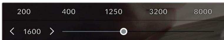
No menu “ISO”, as configurações ISO da sua câmera são exibidas ao longo da parte inferior da tela de toque LCD. O deslizador abaixo das predefinições permite que você ajuste o ISO em incrementos de 1/3 de stop.
