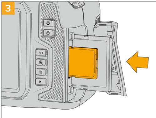
SDカードのラベル面をタッチスクリーンに向けて、SDカードスロットの所定の位置まで挿入します。カードは、過度に力を入れる必要なく簡単に挿入できるはずです。
