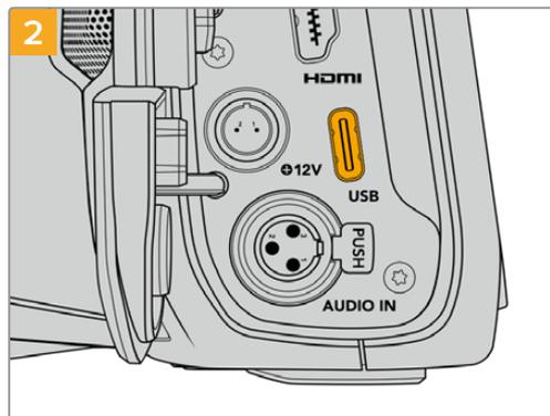
Conecte el extremo de un cable USB-C a la unidad.
