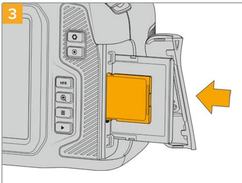
Halten Sie die SD-Karte mit der Beschriftung zum Touchscreen hingewandt und schieben Sie sie in den SD-Kartenschacht, bis sie spürbar einrastet. Die Karte sollte sich ohne übermäßigen Kraftaufwand einführen lassen. Um die SD-Karte zu entfernen und auszuwerfen, schieben Sie sie sanft in die Kamera.
