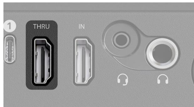
Der HDMI THRU Anschluss gibt eine exakte Kopie des ursprünglichen Signals an den HDMI-Eingang weiter – latenzfrei, mit VRR und 4K60 HDR Unterstützung.
