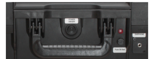
(Fig. 21) LED y fusible en la parte frontal de una carcasa para ATEM Extreme
