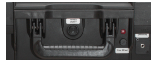
(Figure 21) LED & fusible sur la face avant d'un Case pour ATEM Extreme
