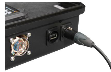
(Fig. 20) Collegamento della batteria della custodia del BSS
