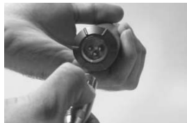
Abb. 5 – Anschluss des XLR-Kabels
