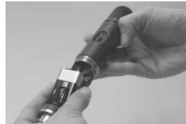
Abb. 2 – Einsetzen der Batterie
