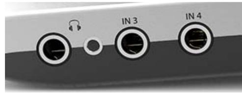
Die Ausgänge 3/4 liegen an zwei **Phones** Stereo-Buchsen an, mit getrennten elektrischen Treiberstufen, optimiert für hochohmige (TRS 6,35 mm) und niederohmige (TRS 3,5 mm) Kopfhörer. Das niederohmige unsymmetrische Ausgangssignal ist qualitativ identisch zu dem des XLR-Ausgangs, aber niedriger im Pegel.
