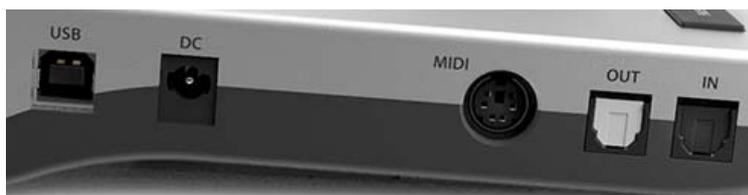
Auf der linken Seite befinden sich je ein optischer TOSLINK Eingang und Ausgang, ein Netzteilanschluss, eine USB-Buchse, sowie eine 6-polige Mini DIN Buchse für das MIDI Breakoutkabel.
