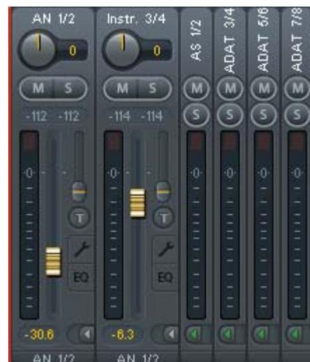
Das unterste Feld zeigt das aktuelle **Routingziel**. Per Mausklick öffnet sich das Routingfenster zur Auswahl eines Routingziels. Alle derzeit für diesen Kanal aktiven Routings sind mit vorangestellten Pfeilen markiert, der aktuelle erscheint in fetter Schrift.
