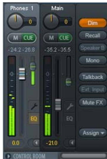
**Speaker B.** Schaltet die Wiedergabe von Main Out auf den Main Out B um. Per Link lassen sich die Fader der Kanäle Main und Speaker B koppeln. Über *Options / Key Commands* lässt sich die Umschaltung auf Speaker B auch mittels der Tasten **OUT**, **A**, **B** und **DIM** des Gerätes durchführen.
