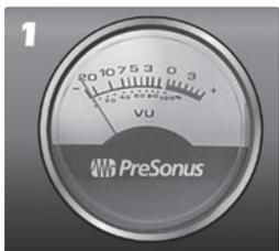
**VU-mètre.** Le VU-mètre analogique affiche le niveau de sortie de votre BlueTube DP V2.
