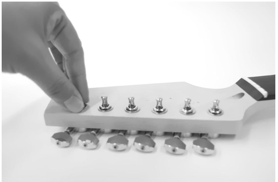
Ziehen Sie die Muttern auf der Vorderseite mit einem passenden Schraubenschlüssel, und anschließend die Schrauben zum Fixieren der Mechanik auf der Rückseite fest an.
