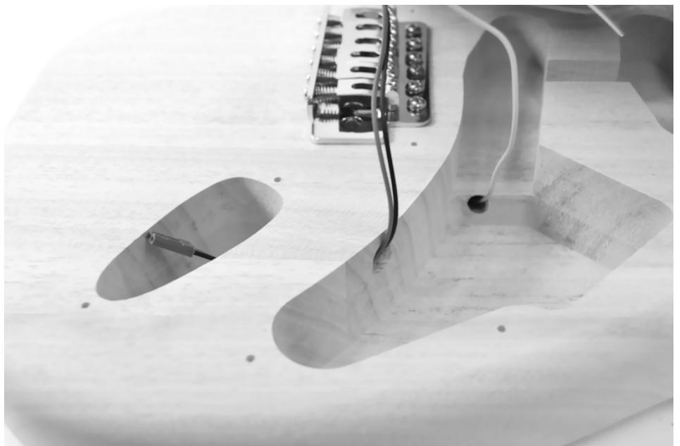
Führen Sie das Kabel für die Saitenerdung (abisoliert, ohne Steckverbinder) durch den Kanal in die rückseitige Aussparung zum Federblech.
