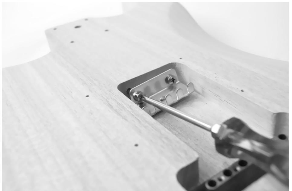
Befestigen Sie die Ösen der drei Federn am Federblech und führen Sie die anderen Enden in die kleinen Löcher im Sustainblock. Ziehen Sie nun die Schrauben des Federblechs fester in Richtung Hals an, bis der Steg unter genügend Spannung steht.
