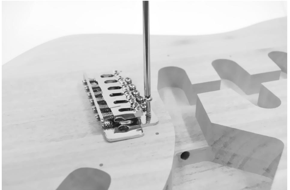
Drehen Sie anschließend den Korpus um und verschrauben Sie das Federblech handfest in die vorgebohrten Schraublöcher in der Ausfräsung auf der Korpusrückseite.
