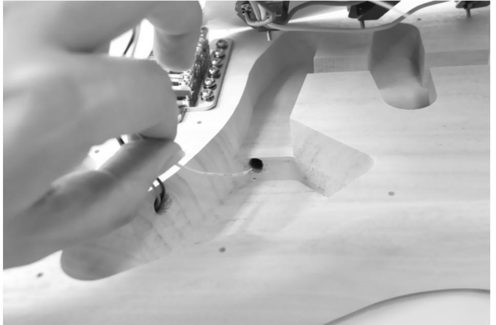
Hängen Sie das Erdungskabel am Federblech ein. Achten Sie hierbei auf ausreichenden Kontakt zwischen dem abisolierten Ende des Erdungskabels und dem Federblech.
