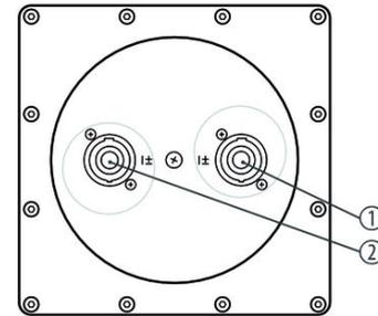
1, 2 Terminales NL4 cableados en paralelo (señal de baja frecuencia vía 1+/1-, señal directa vía 2+/ 2-)
