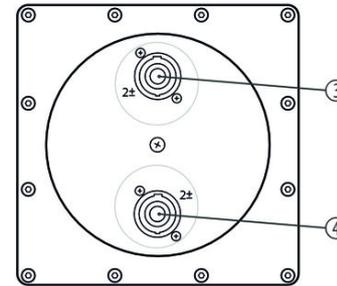
3, 4 Terminales NL4 cableados en paralelo (señal de baja frecuencia vía 2+/2-, señal directa vía 1+/1-)
