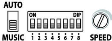
Setzen Sie alle DIP-Schalter auf „OFF“ (Aus).
