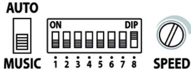
Setzen Sie den DIP-Schalter 8 auf „ON“ (Ein).
