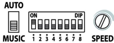
Setzen Sie den DIP-Schalter 8 auf „OFF“ und mindestens einen der anderen DIP-Schalter auf „ON“. Die Kanalbelegung erfolgt wie in der Übersicht dargestellt:
