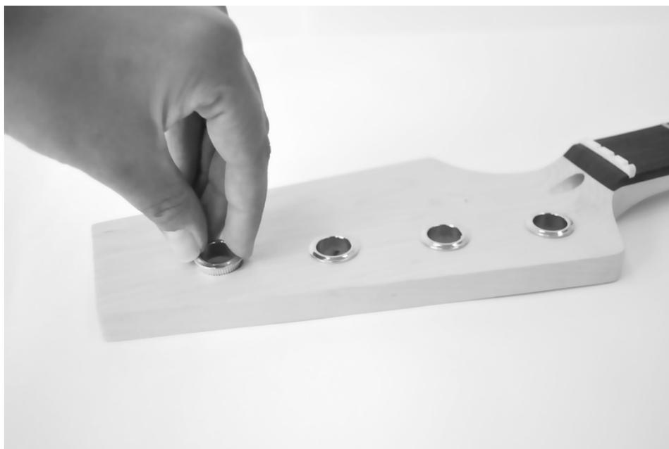
Setzen Sie die Stimmmechaniken von der Rückseite der Kopfplatte aus in die vorgesehenen Bohrungen ein. Richten Sie die Mechaniken so aus, dass die Stimmwirbel senkrecht zur Oberkante der Kopfplatte stehen.
