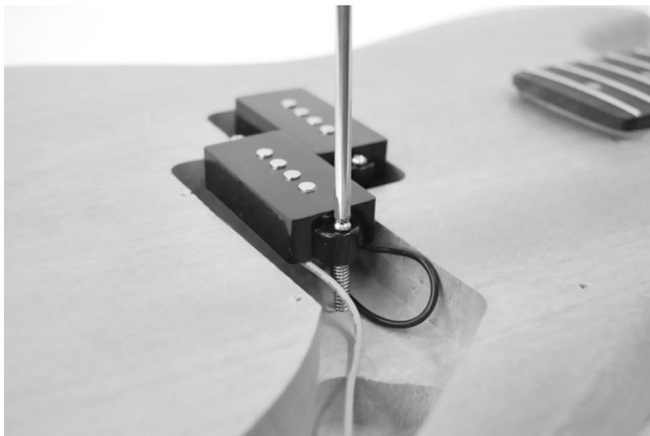
Führen Sie das Kabel für die Saitenerdung (abisoliert, ohne Steckverbinder) durch den Kanal aus der Aussparung für die Potis in die frontseitige Bohrung.
