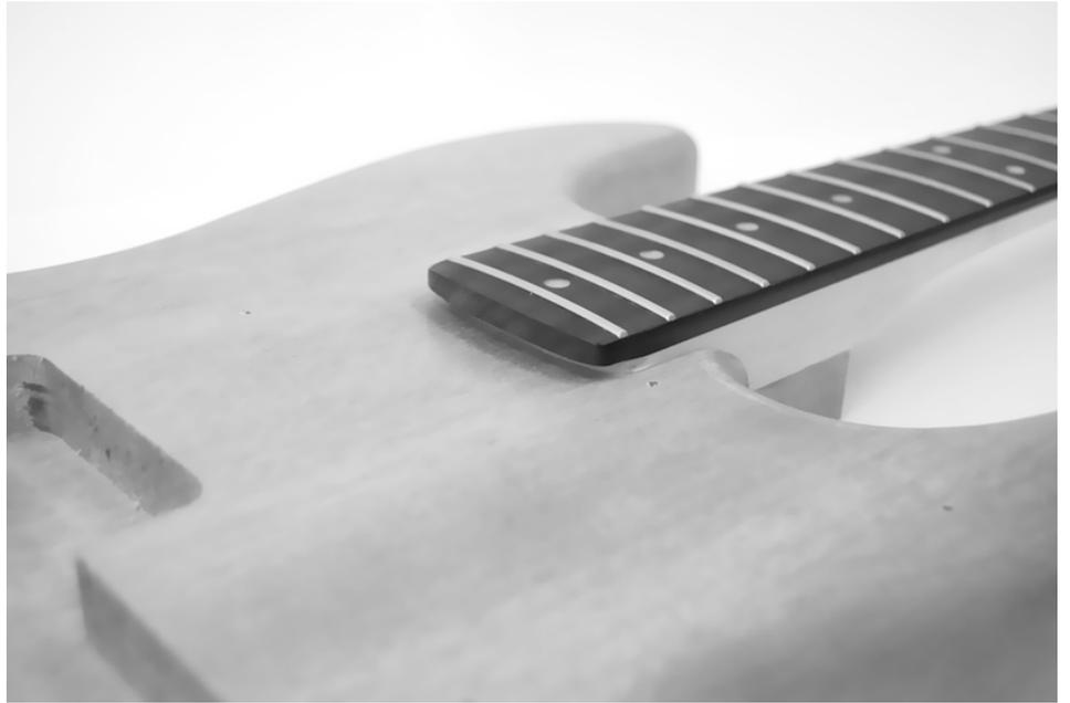
Drehen Sie die Bassgitarre um, legen Sie die Anschraubplatte über die vier Schraubenlöcher auf der Korpusrückseite und schrauben Sie die vier mitgelieferten langen Holzschrauben durch die Löcher der Anschraubplatte in den Korpus und Hals, bis die Verbindung fest sitzt.
