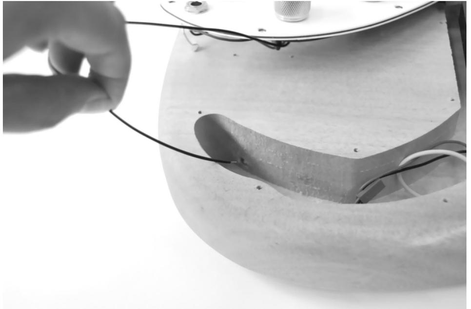
Führen Sie das Kabel soweit aus der Bohrung heraus, dass bei der Montage des Stegs ein ausreichender Kontakt mit der metallischen Oberfläche entstehen kann. Durch die Saitenerdung werden Störgeräusche (Brummen) reduziert.
