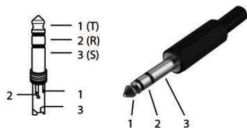
Configuración no balanceada (conector jack estéreo):
