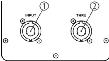
1, 2 Auf der Rückseite zwei parallel verdrahtete NL4-Anschlüsse (SpeakON)
