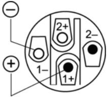
Die nebenstehende Abbildung zeigt die Belegung des verriegelbaren NL4-Einbausteckverbinders (1+/1-).
