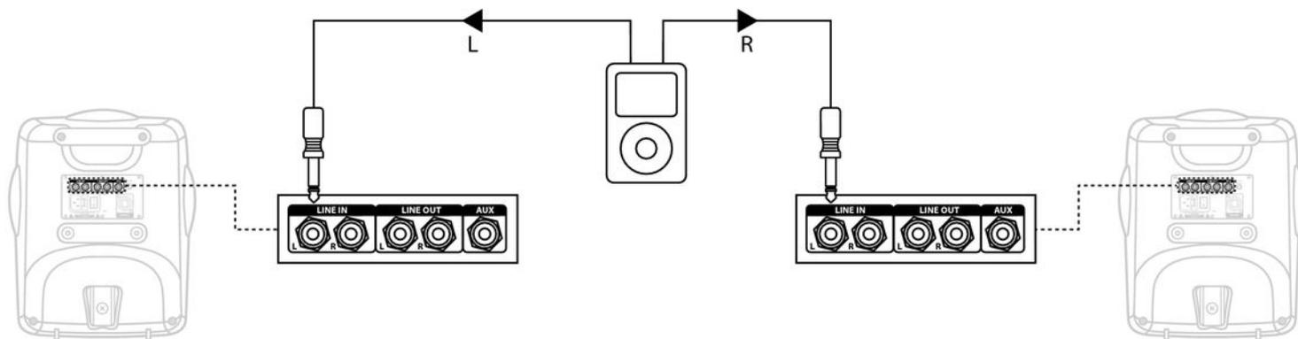
**Line- und Mikrofon-Signal direkt in die Box gespeist, rechter Kanal durchgeschleift auf zweiten RA10**
