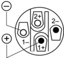
Diese Anschlüsse ermöglichen eine einfache Verkabelung mit vieradrigen Kabeln, da die Top-teile ihr Signal an den Adern 1+ / 1- erhalten und die Adern 2+ / 2- durchverbinden; der Bass ist an die Adern 2+ / 2- angeschlossen und verbindet die Adern 1+ / 1- durch. Die Reihenfolge, in der die Lautsprecher verkabelt sind, ist unwichtig. Beachten Sie aber die minimale Lastimpedanz der Verstärker.
