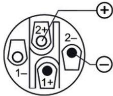
Die nebenstehende Abbildung zeigt die Belegung der verriegelbaren NL4-Einbausteckverbinder.
