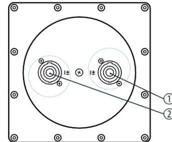
1, 2 Parallel verdrahtete NL4-Anschlüsse (1+/1– zum Bass; 2+/ 2– durchverbunden)
