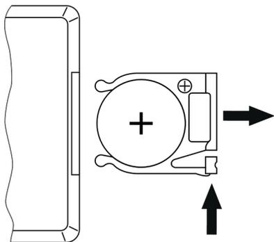
Empuje con el dedo sobre el bloqueador del portabatería y tire del mismo para sacarlo de la carcasa. Inserte la batería. Procure que el polo + muestre hacia el fondo del telemando. Inserte el portabatería en el telemando, empujando hasta que quede enclavado.
