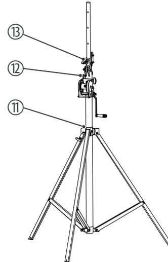
1. ➤ Lösen Sie die Sicherungsschraube [1] am Schlitten. Ziehen Sie den Sicherungsbolzen [11] aus dem Hauptrohr [4] heraus und klappen Sie die Füße des Stativs [2] auseinander, bis der Sicherungsbolzen [11] in gewünschter Position im Hauptrohr [4] einrastet.
