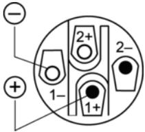
La ilustración muestra la asignación del conector NL4 con mecanismo de cierre.
