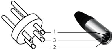
Los terminales combinados XLR/jack de 6,35 mm (balanceados) funcionan como entradas de señales. La ilustración y la tabla muestran la asignación de los pins de la conexión XLR.
