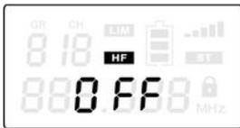
Appuyez sur **[SET]** à plusieurs reprises jusqu'à ce que « **ON** » ou « **OFF** » et le champ « **HF** » clignotent à l'écran. Utilisez les touches **▲** ou **▼** pour activer ou désactiver l'accentuation des hautes fréquences (affichage « **ON** » ou « **OFF** »). Si la fonction est activée, les fréquences sont accentuées de 6 dB à partir de 10 kHz et le champ « **HF** » s'affiche à l'écran. Aucune accentuation n'a lieu si la fonction est désactivée.
