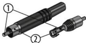
La siguiente ilustración y la tabla muestran la asignación de los pins de un conector tipo Cinch.
