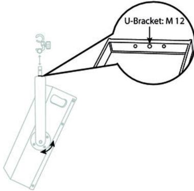
Mit den als Zubehör erhältlichen Haltebügeln (U brackets) für vertikale und horizontale Montage können Sie den Lautsprecher stabil und sicher an der Wand, der Decke oder einer Rohrklemme (half coupler) und damit an Traversen befestigen.
