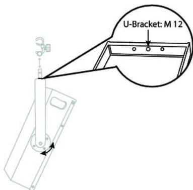
Les arceaux de retenue (U brackets) disponibles en accessoires pour montage vertical et horizontal vous permettent de fixer les haut-parleurs de manière stable et en toute sécurité au mur, au plafond ou dans un demi-coupleur (half coupler) pour les fixer ensuite sur des traverses.
