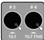
**4.** ➤ Tournez la molette jog # 4 pour sélectionner un profil dans le recueil de profils STAIR-VILLE. Tournez la molette jog # 3 pour sélectionner un profil dans le recueil de profils d'un autre fabricant.
