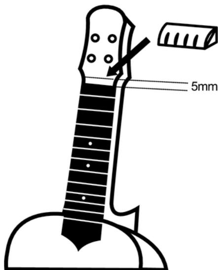
La cejilla se monta encima del diapasón en el mástil (se requiere una distancia de 5 mm entre el diapasón y el clavijero, ver apartado anterior). Aplique cola para madera en las superficies de unión de los dos componentes. Fije los dos componentes con anillos de goma, hasta que la unión se haya secado.
