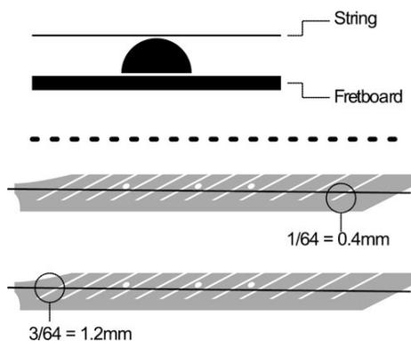
La distancia ideal en el primer traste es de 0,4 mm, en el 12º traste 1,2 mm, aproximadamente. Si es necesario, compruebe las uniones y el posicionamiento de los componentes del instrumento.
