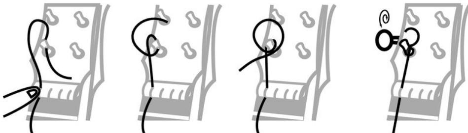
Enhebra las cuerdas en los taladros de la clavija prevista. Procure fijar cada cuerda dando entre dos y tres vueltas en la clavija, ver figura. Tense las cuerdas sin aplicar demasiada fuerza y compruebe la distancia entre las cuerdas y el diapasón.
