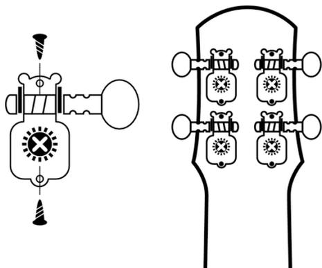
Fije pegando los anillos de fijación de las clavijas desde la cara frontal en el clavijero.
