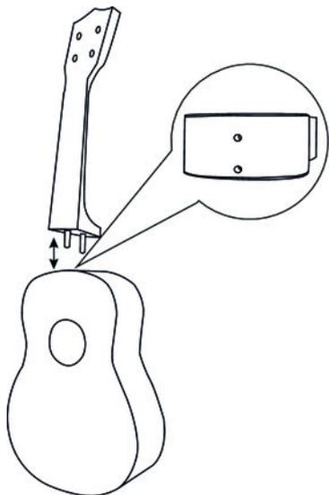
El mástil se fija por medio de una unión machihembrada en el cuerpo. En primer lugar, debe comprobar que el mástil encaja correctamente con el cuerpo. Es natural que la madera cambie ligeramente su forma con el paso del tiempo. Si el mástil queda demasiado apretado en la ranura del cuerpo, es posible que sea necesario un ligero ajuste con un cincel afilado o papel abrasivo.
