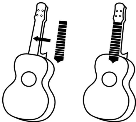
El diapasón se fija pegando en el mástil. Aplique cola para madera en las superficies de unión de los dos componentes. Ponga y alinee el diapasón en el mástil de manera tal que quede una ranura de 5 mm en el extremo del clavijero para montar la cejilla. Fije los dos componentes con anillos de goma, hasta que la unión se haya secado.
