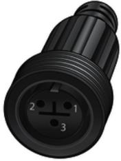
La salida DMX consiste en un acoplador de tres polos, la entrada DMX consiste en un conector de tres polos, ambos con tipo de protección IP 65. La ilustración y la tabla muestran la asignación de los pins de un acoplador adecuado.
