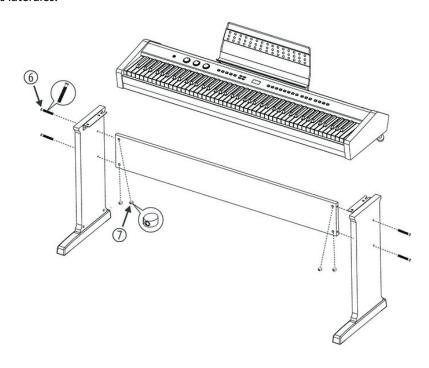
Sitúe la caja del piano digital en el mueble y fíjela con cuatro tornillos M6 × 16.
