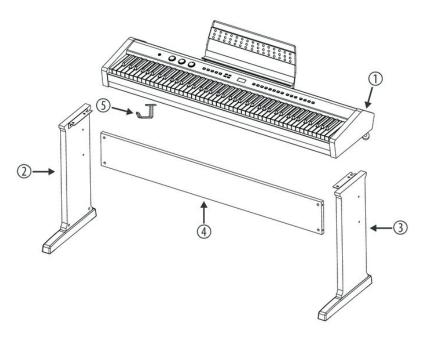
Para montar el piano digital, se requiere un destornillador para tornillos de cabeza ranurada en cruz (no forma parte del suministro). Desembale el paquete suministrado y compruebe la existencia de todos los componentes a partir de la siguiente lista.
