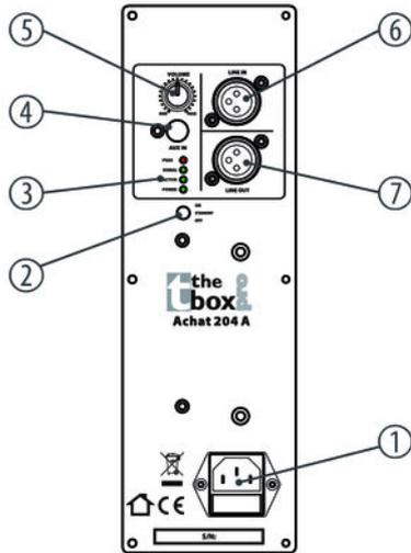
1 Anschluss für die Versorgungsspannung
