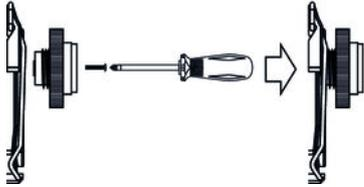
Zur Demontage heben Sie den Klemmbügel an und schieben Sie den Blitzschuh-Adapter nach unten heraus.
