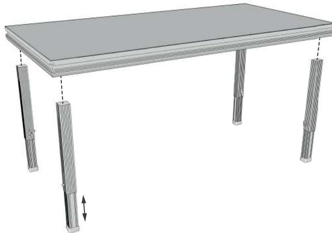
1. Führen Sie die Steckfüße in die vorgesehene Aussparung auf der Unterseite des Bühnenpodests ein.
