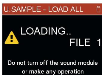
Während des Ladevorgangs werden die Eintragsnummern angezeigt, so dass ersichtlich ist, welche Dateien bereits geladen sind. Nach Beendigung des Ladevorgangs werden die Anzahl der geladenen und nicht geladenen Dateien angezeigt.
