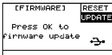
1. ➤ Speichern Sie die heruntergeladene Firmware auf einem USB-Flash-Laufwerk (USB-Stick). Das Percussion Pad erkennt automatisch das Firmware-Update bei der Installation.
