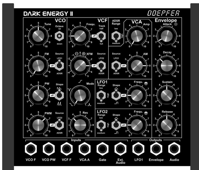
Nach dem Anschluss des Steckertrafos ist Dark Energy II eingeschaltet. Die beiden LEDs in den Sektionen LFO 1 und LFO2 sollten nun leuchten bzw. im Wechsel rot/grün blinken. Die LED auf der Rückseite blinkt ca. 2 Sekunden in schneller Folge und leuchtet dann permanent.
