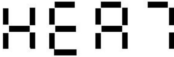
Das LC Display zeigt mit diesem Text an, dass das Gerät aufheizt im Moment. Diese Meldung kann auch auftauchen wenn die Maschine nach heizen muss. Wenn die Maschine aufgeheizt ist wird wieder ADDR im Display angezeigt.
