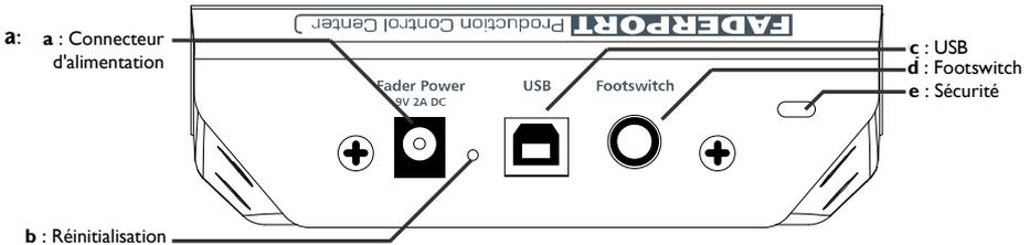
**a. Connecteur d'alimentation** Branchez ici l'adaptateur secteur CC 9V 2A. Le fader motorisé ne fonctionnera pas sans cette alimentation connectée.
