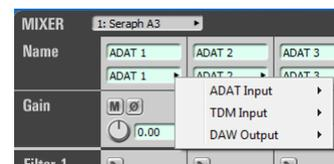
6. Für ein Stereosignal nutzen Sie 2 Kanäle und verbinden diese über den Linkschalter am unteren Ende des ersten Kanalzuges.
