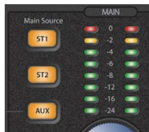
**Tasten Main Source:** Über die Tasten Main Source wählen Sie das Audiosignal aus, das über die Lautsprecherausgänge und die Line-Ausgänge Main L/R ausgegeben wird sowie über alle Kopfhörerausgänge, deren Source-Tasten sich in der Stellung Main (nicht gedrückt) befinden.
